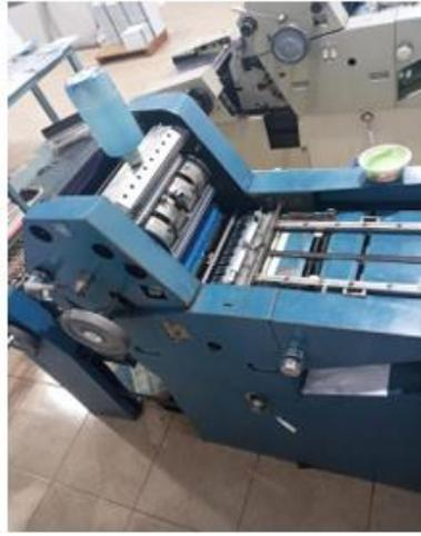
**Ilustración 7: MAQUINA OFFSED KOLOR MATE 23X42**
