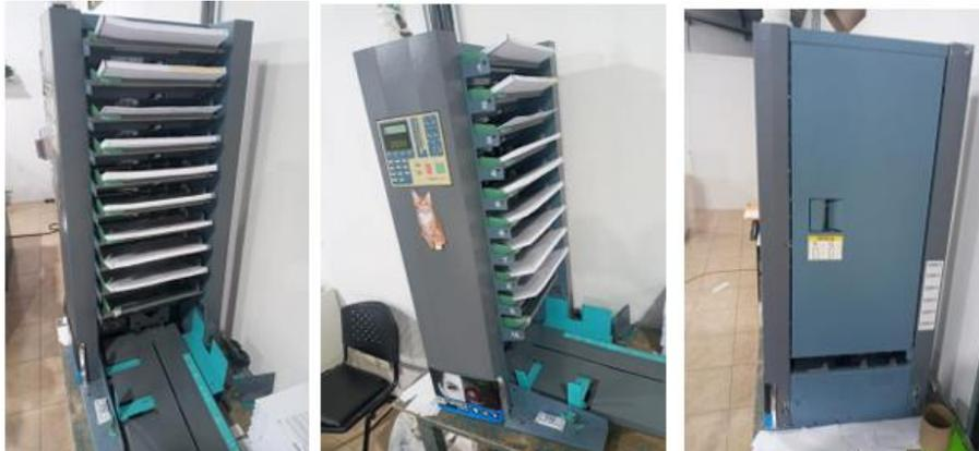
**Ilustración 5:** *MAQUINA INTERCALADORA DE HOJAS DUPLO DFC-10*
