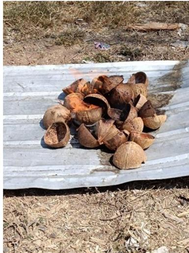
*Nota.* La cáscara de coco seco fue quemada en un zinc para evitar cualquier contaminación con la ceniza de cáscara de coco seco. Elaboración propia
