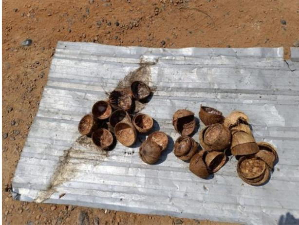
*Nota.* La cáscara de coco seco fue expuesta al sol para eliminar cualquier humedad residual antes de su calcinación, asegurando así la calidad de la ceniza obtenida.
