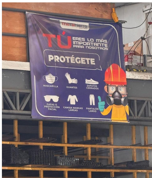
Figura 23. Lona informativa de seguridad ubicada en el área de almacenamiento, que promueve el uso obligatorio de EPP: mascarilla, guantes, gafas, camisa de manga larga, pantalón largo y zapatos cerrados.
