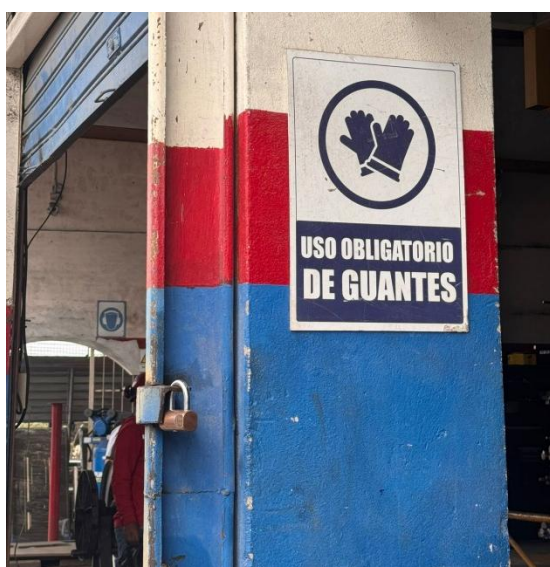
Figura 18. Señal de uso obligatorio de guantes ubicada en el ingreso al área operativa, como medida preventiva ante riesgos de corte y manipulación de materiales.
