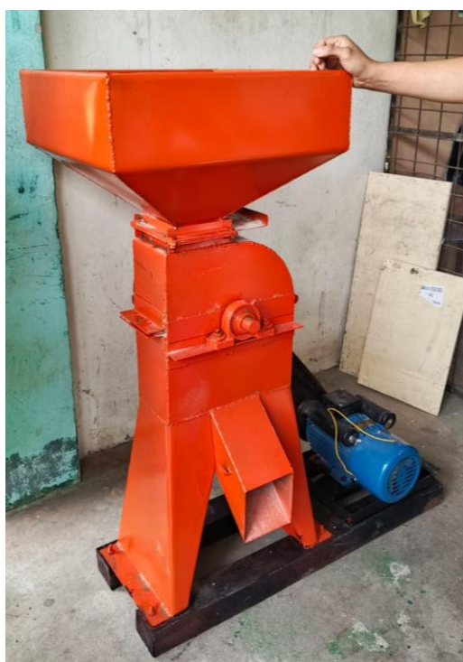
Ilustración 6 Molino Industrial de 6qq
