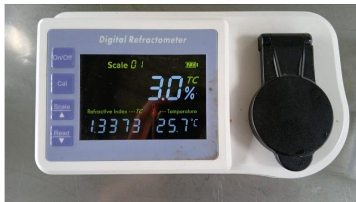
Ilustración 13 Medición de grados brix
