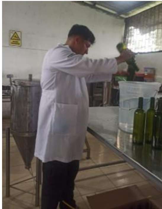
Ilustración 7 Esterilización de envases mediante solución de metabisulfito de sodio
