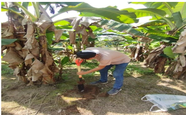
Anexo 6. Muestreo de suelo con pala en cultivo de plátano
