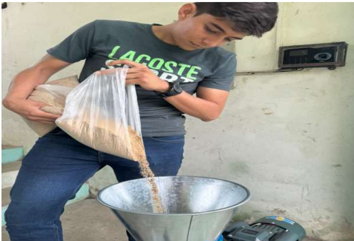
Anexo 3: Colocación de suplementos mezclados en textura harinosa en la peletizadora.
