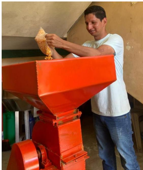
El molino procesó el grano de manera eficiente, transformándolo en una harina de textura fina y homogénea, característica esencial para facilitar la posterior mezcla con el aditivo. La apariencia del maíz ya procesado, con su granulometría reducida, se puede observar en la Figura 4.
