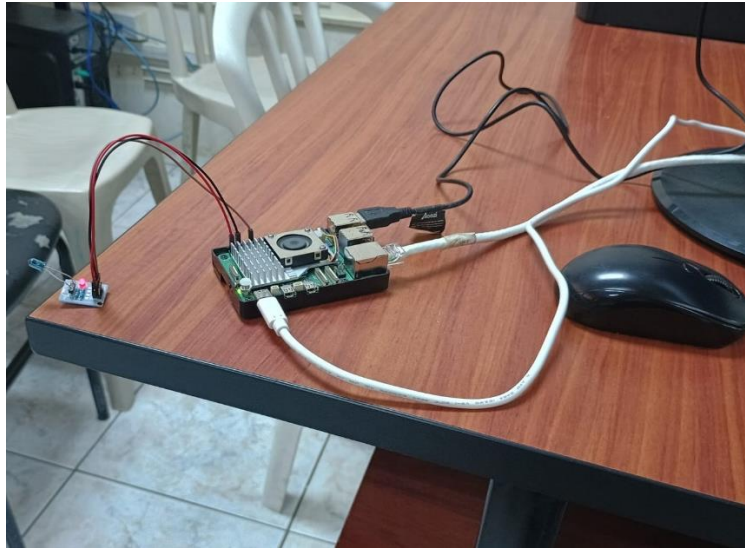
Anexo 3 Emisor IR enviando señal al aire acondicionado
