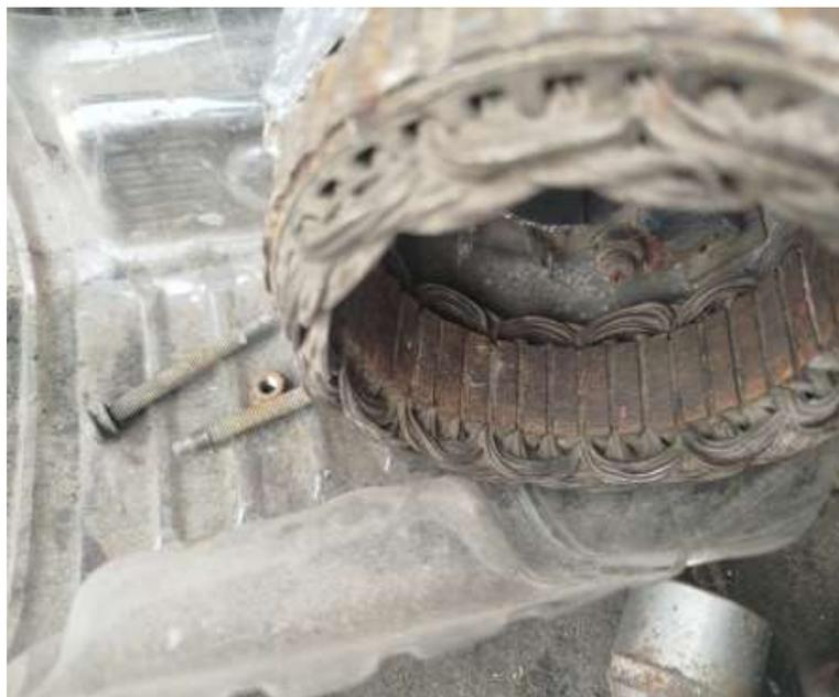
**Figura 71.** Estator del alternador
