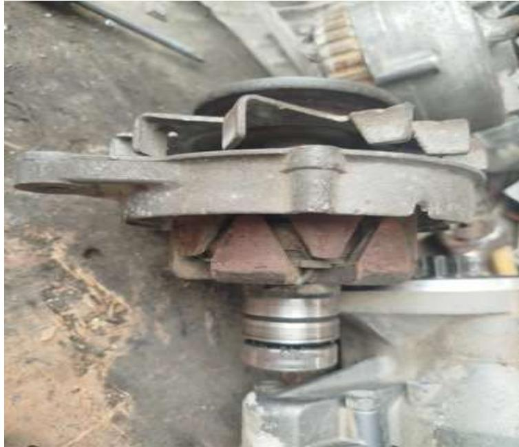
**Figura 70.** Rotor del alternador
