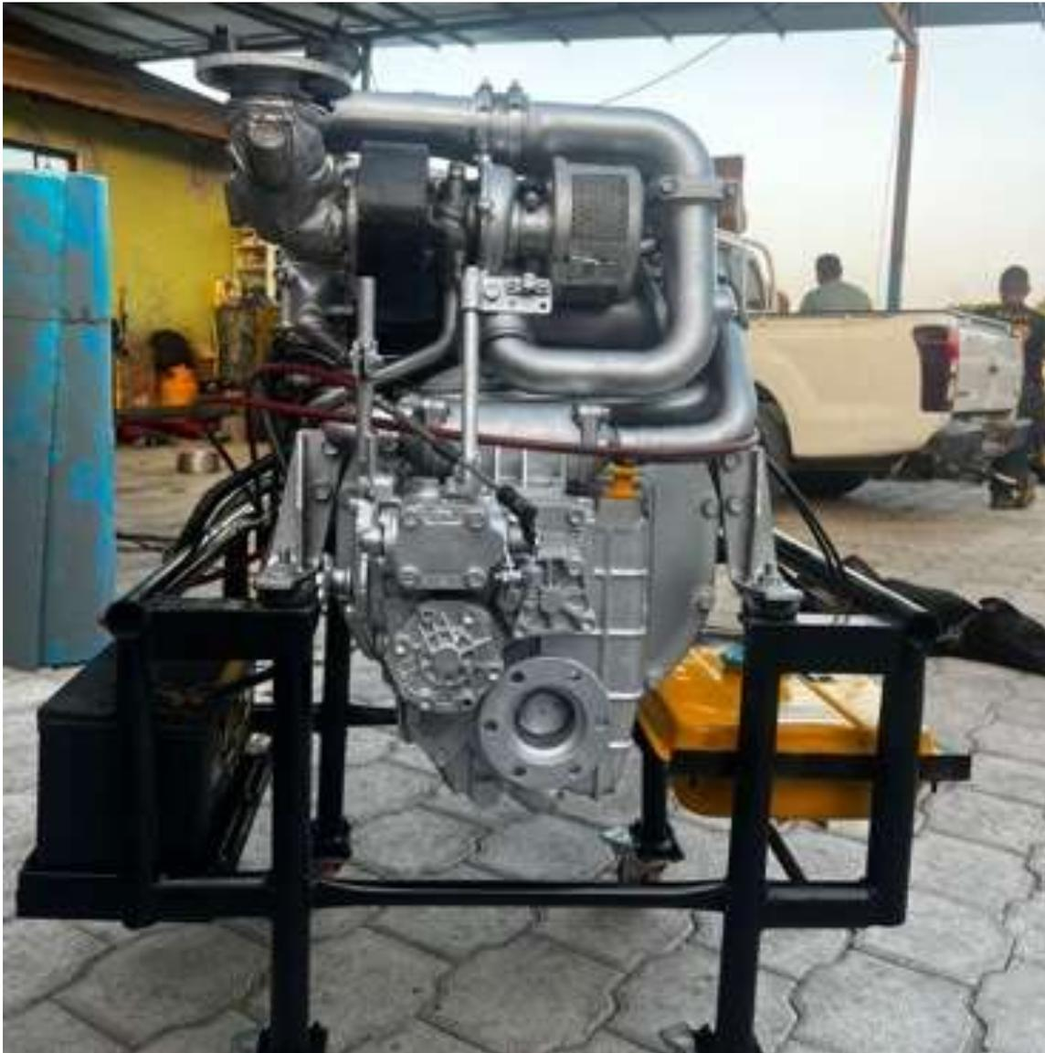
**Figura 83.** Se coloco filtro de aire en el turbocompresor
