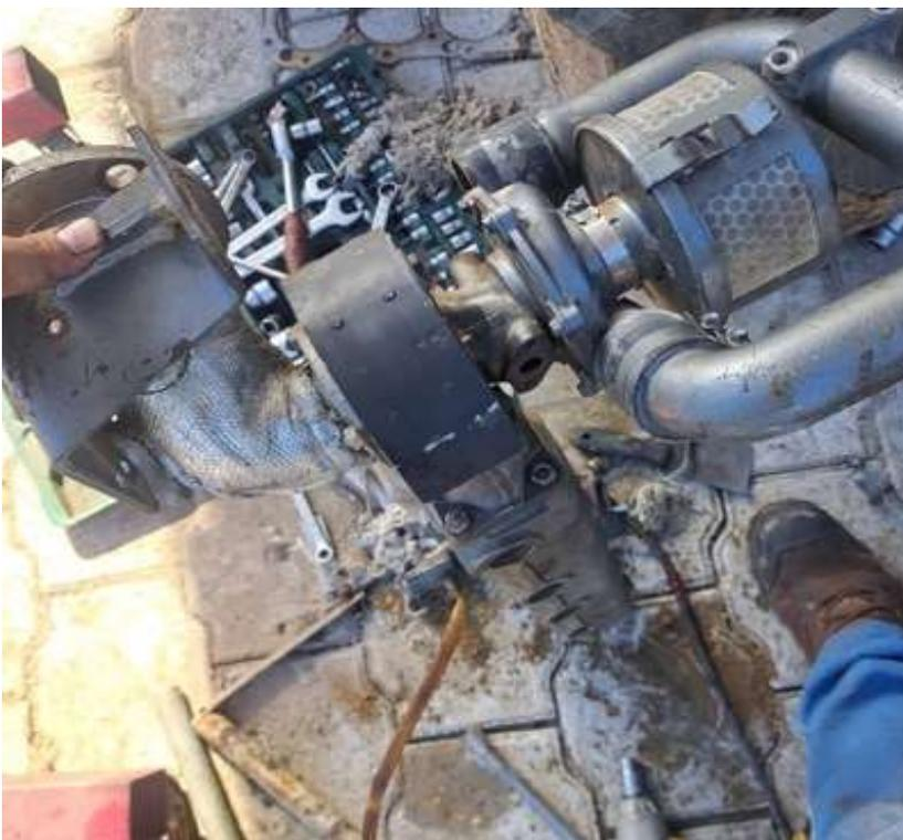
**Figura 62.** Desarme del sistema de admisión forzada.
