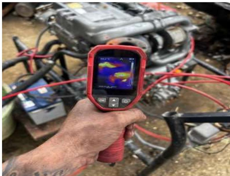
Figura 39. Temperatura del escape en 71.8 °C. La temperatura está dentro del rango de operación.
