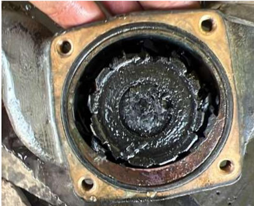
**Figura 59.** Impeler de la bomba marina totalmente fragmentado.
