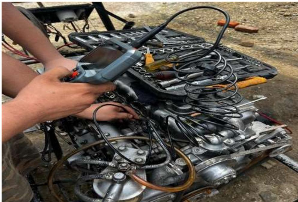
**Figura 33.** Inspección visual interna mediante boroscopio (a través del alojamiento de los inyectores).
