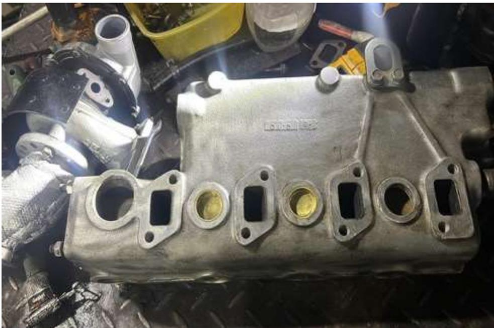
**Figura 77.** Colocación de los nuevos sellos de bronce en el sistema de refrigeración.
