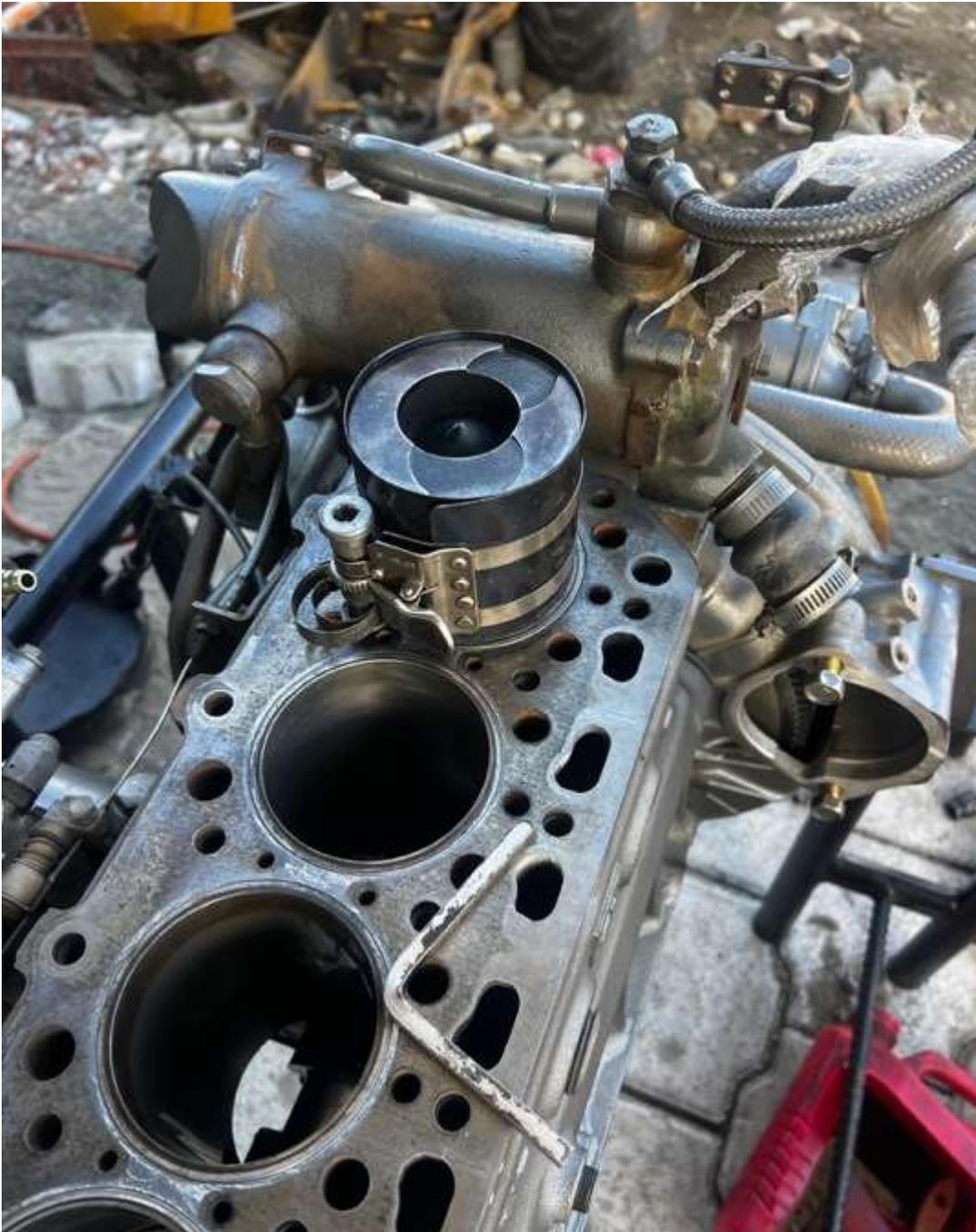
**Figura 72.** Colocación del pistón #1 con la faja de compresión de rines.
