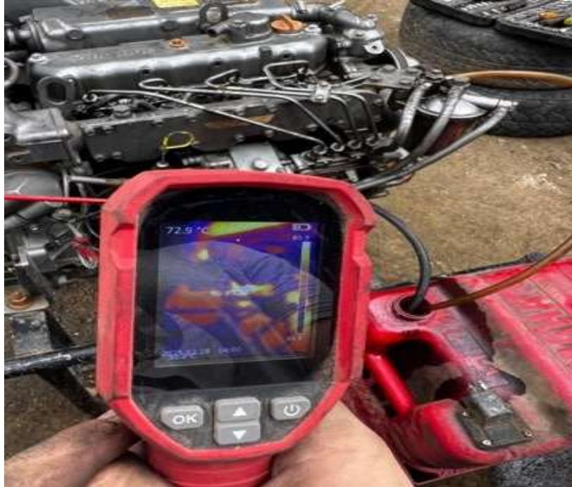
Figura 38. Irradiación de calor del cárter en 80.9 °C. La temperatura está dentro del rango de operación.
