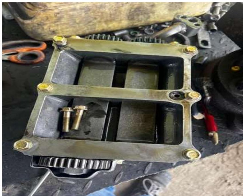
**Figura 51.** Balancador de cigüeñal en óptimas condiciones. Se realizará limpieza.
