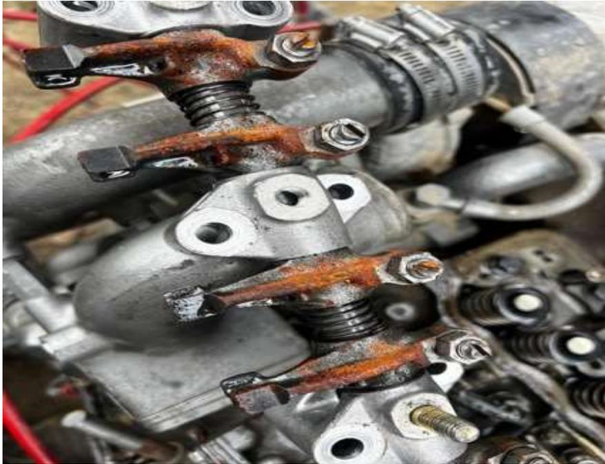
**Figura 44.** La oxidación del árbol de levas y balancines se debe a que el motor estuvo sin funcionamiento durante un largo periodo
