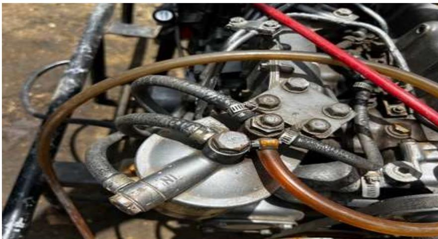
**Figura 29.** Se reemplazo todo el sistema de combustible, así como, el filtro de combustible
