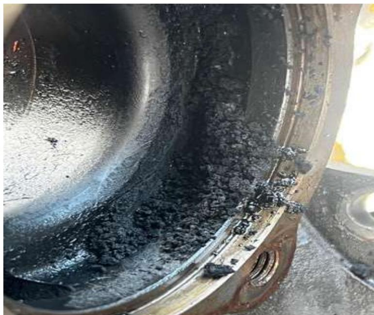
**Figura 64.** Presencia de hollín y depósitos de carbón
