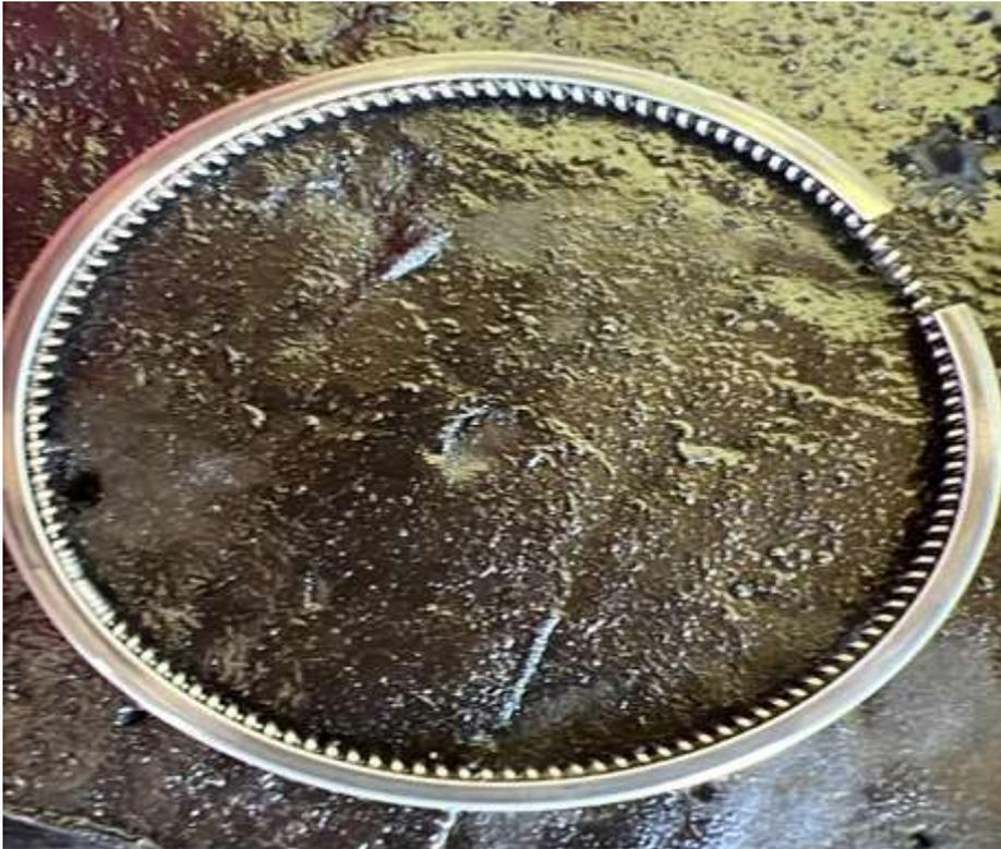
**Figura 57.** Segmento de lubricación en óptimas condiciones del pistón #4
