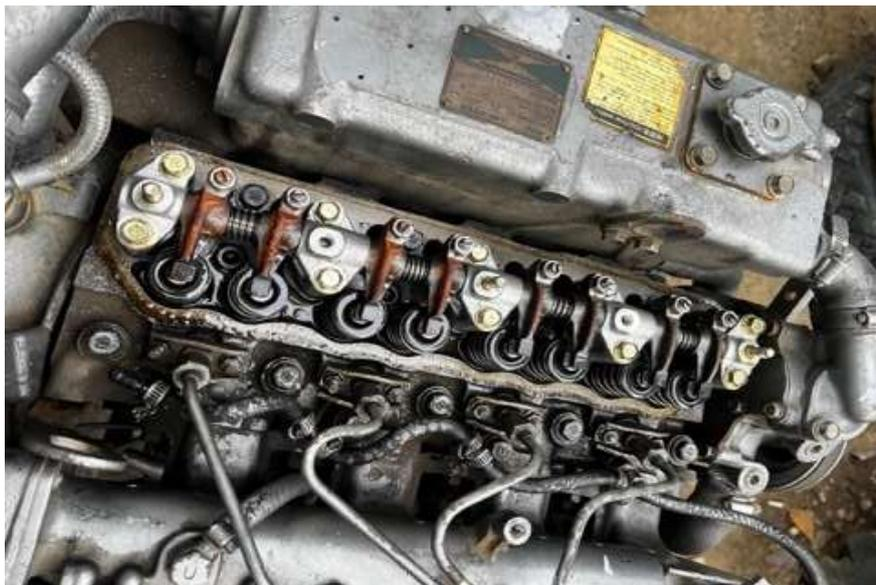
**Figura 43.** La oxidación del árbol de levas y balancines se debe a que el motor estuvo sin funcionamiento durante un largo periodo
