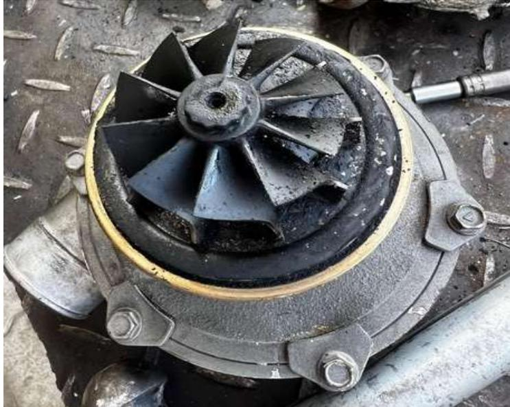
**Figura 65.** Rueda compresora con hollín y carboncillo debido a una combustión incompleta.
