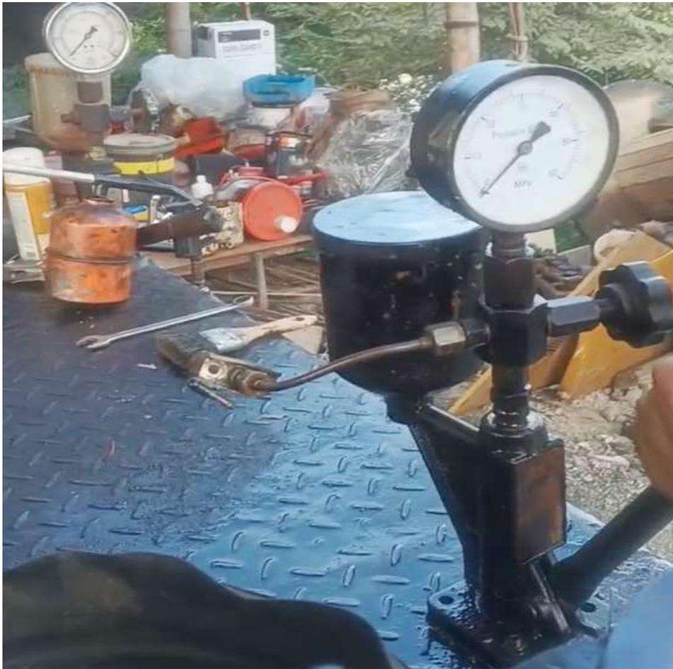
**Figura 90.** Prueba de presión al inyector #4.
