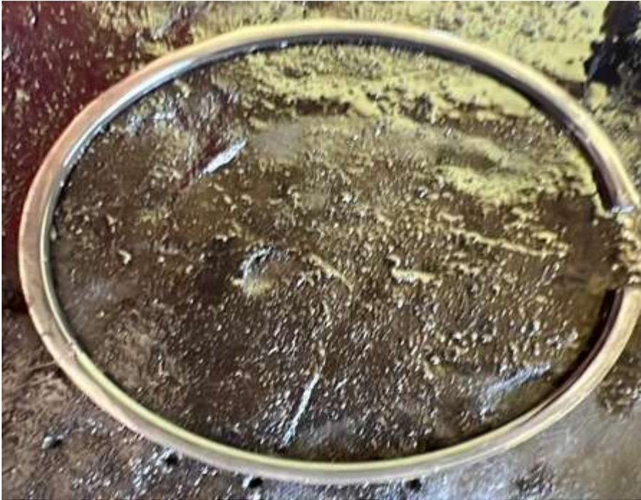
**Figura 55.** Segmento de fuego en óptimas condiciones del pistón #4.
