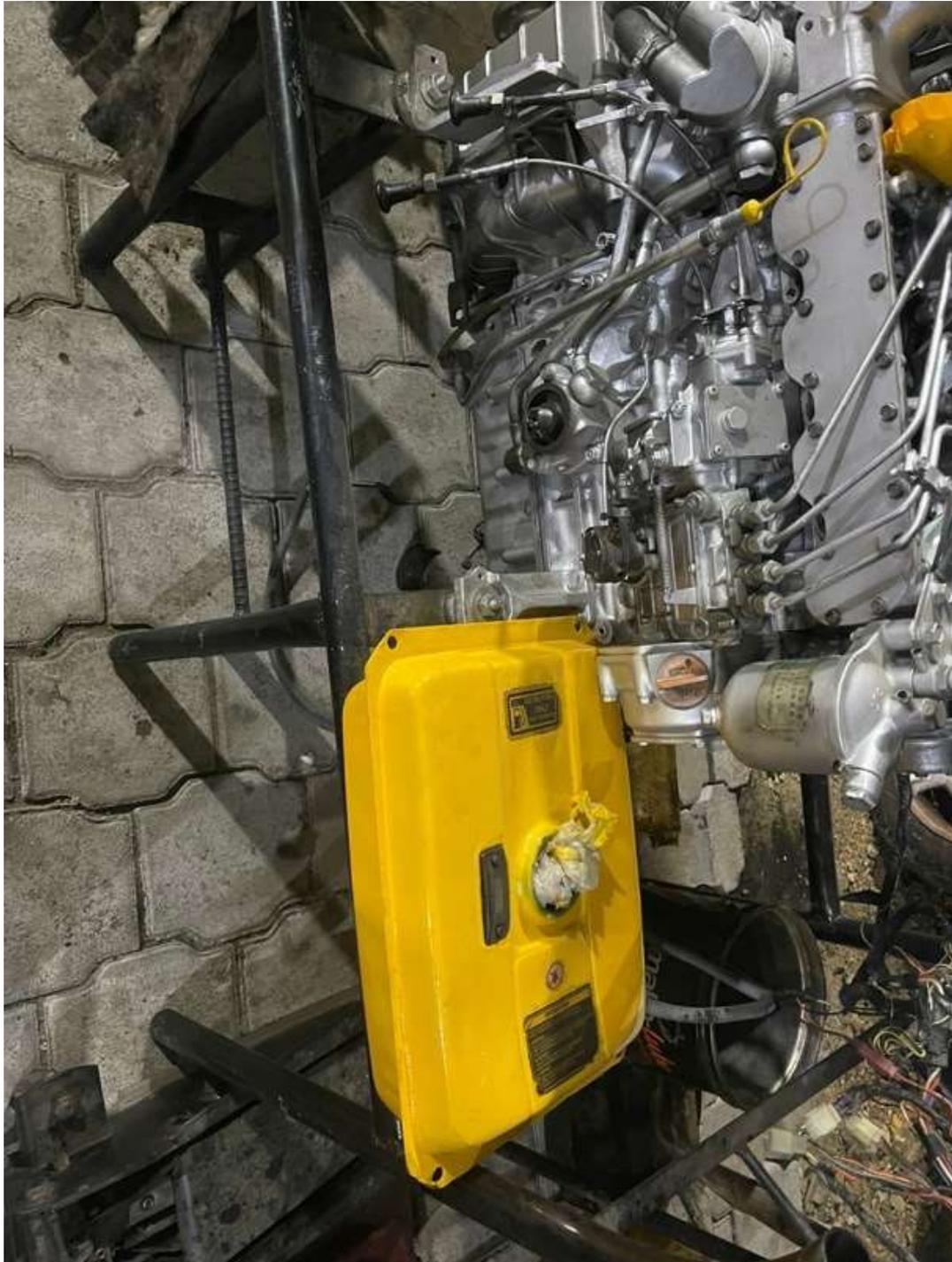
**Figura 82.** Se reemplazo las mangueras de combustible del tanque hasta la inyección.
