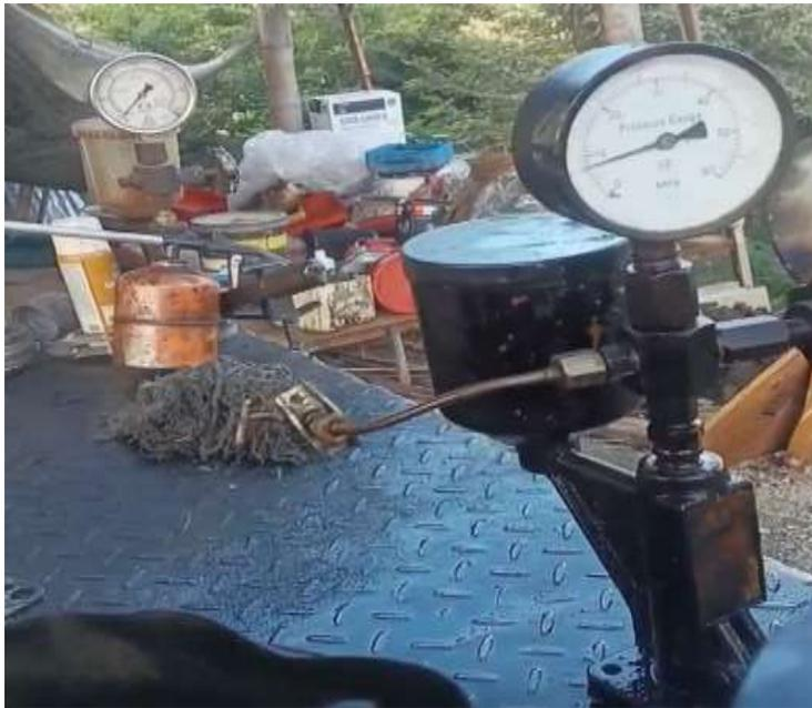
**Figura 88.** Prueba de presión y atomización del inyector #2.
