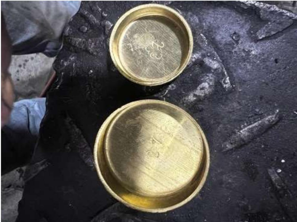
**Figura 76.** Instalación de nuevos sellos de bronce en el sistema de refrigeración de 23mm y 40mm.
