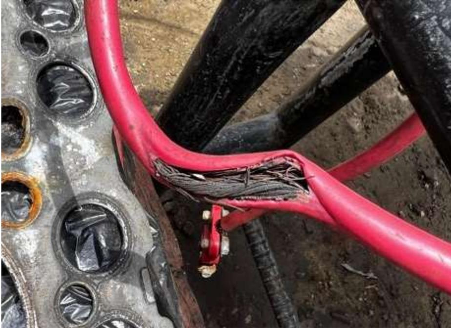
**Figura 26.** Cable positivo de la conexión de batería deteriorado
