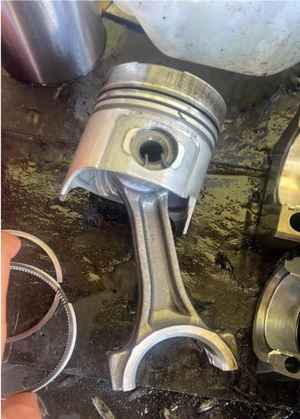
**Figura 54.** Pistón, biela, bulón y segmentos #4 en buenas condiciones.
