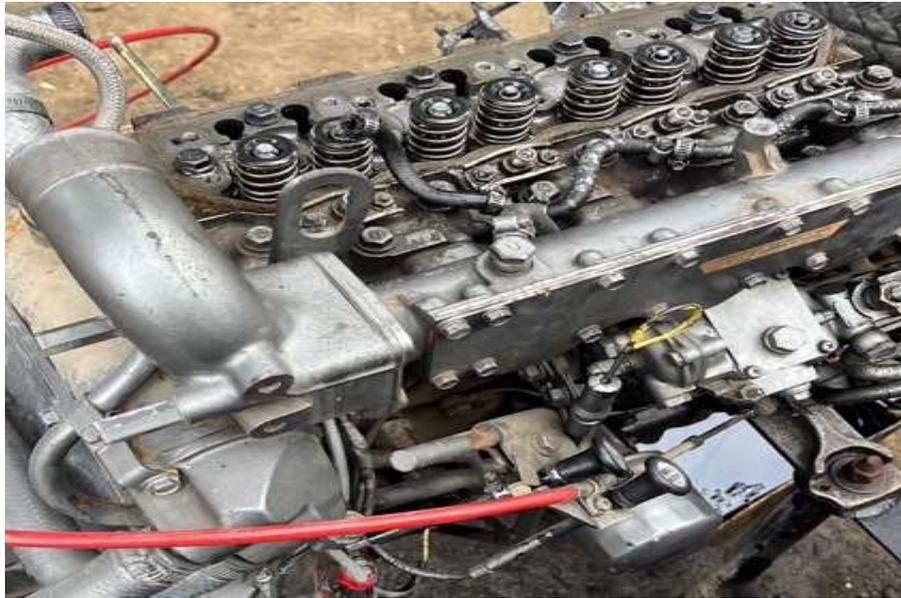
**Figura 46.** Se observó que existía fuga de combustible en las mangueras de inyección
