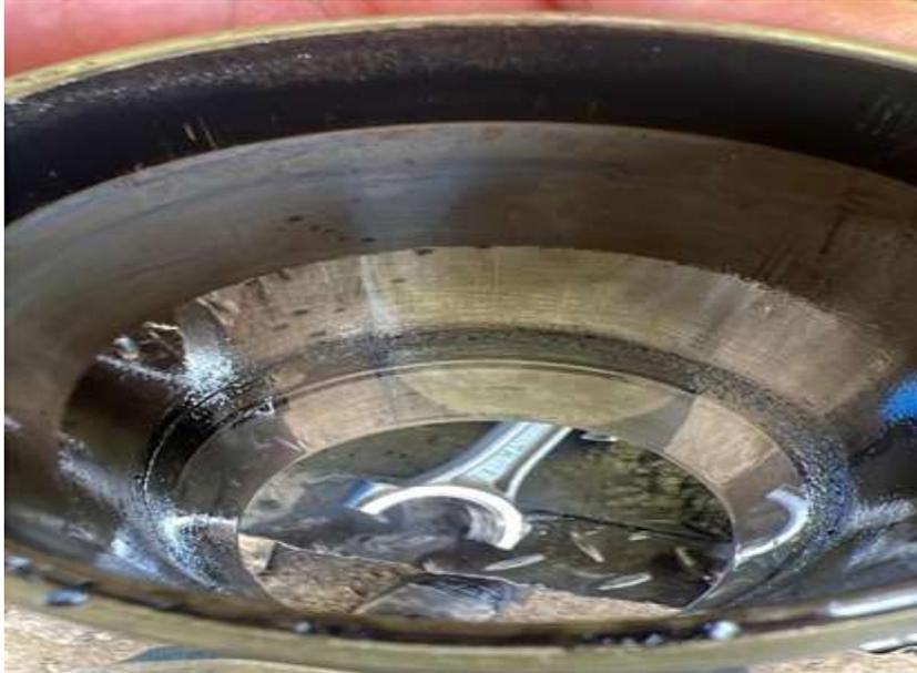
**Figura 52.** Camisa de cilindro #1 con presencia de carbonización de aceite y hollín. Se cambiaron los segmentos del pistón #1.
