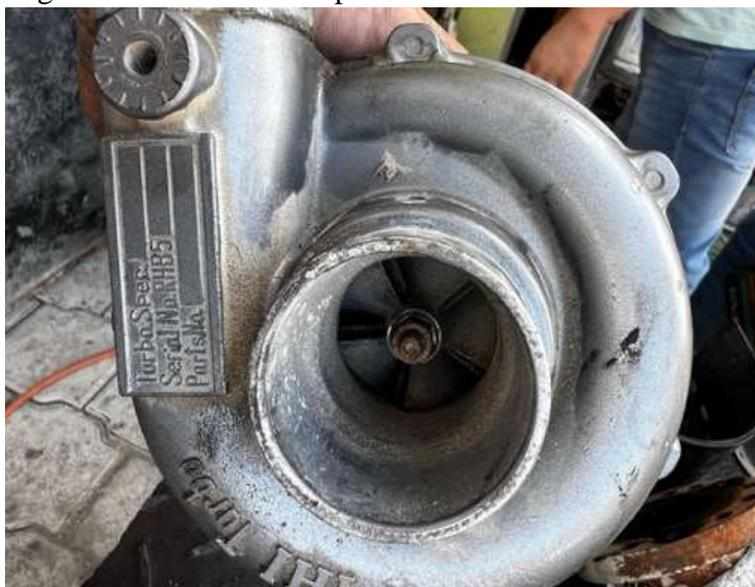
**Figura 66.** Visualización de la carcasa del turbocompresor.
