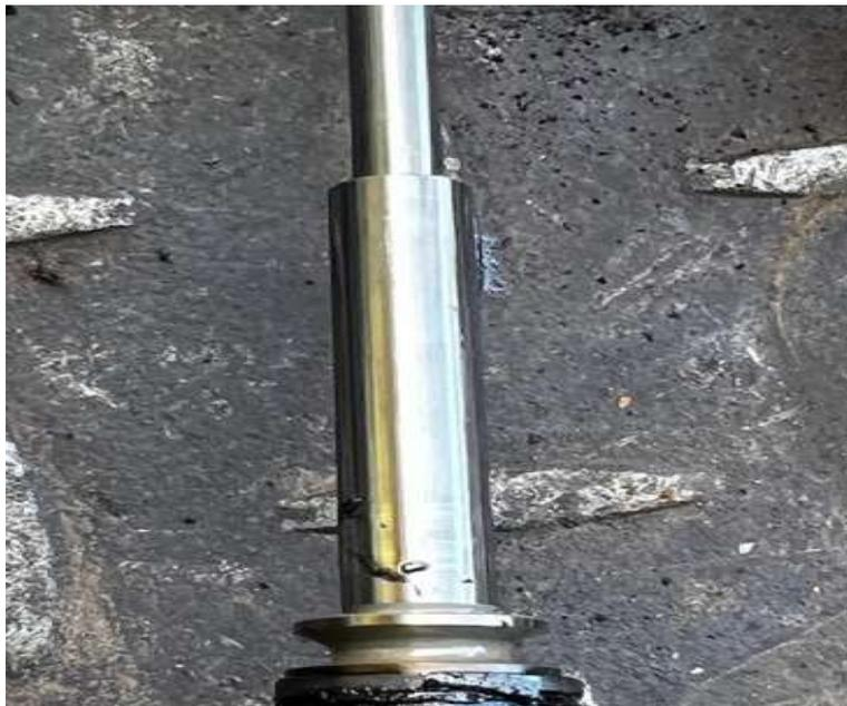
**Figura 67.** Rayadura en el eje de la turbina.
