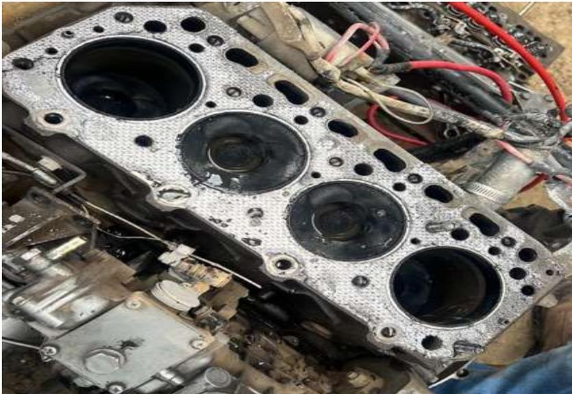
**Figura 48.** Junta del block deteriorado
