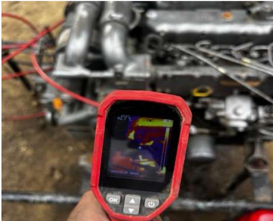
**Figura 40.** Temperatura de 72.2 °C en la bomba de combustible. La temperatura está dentro del rango de operación.
