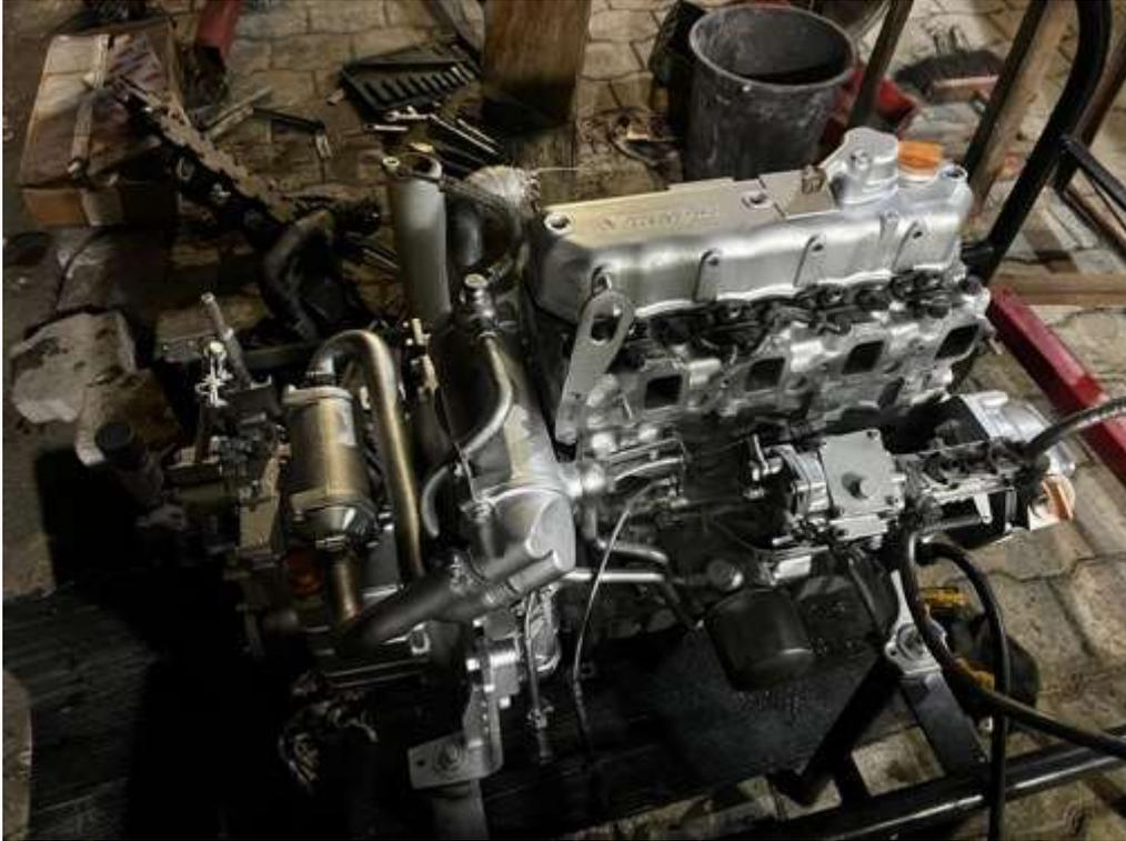
**Figura 78.** Montaje de intercambiador de calor de la caja reductora, cambios de sellos para garantizar estanqueidad.
