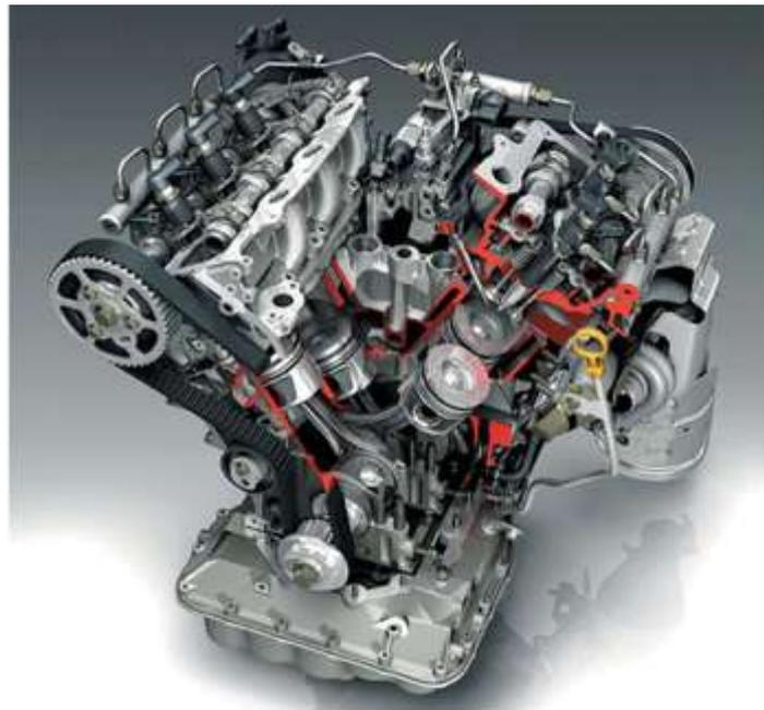
**Figura 7.** Constitución de un motor diésel.
