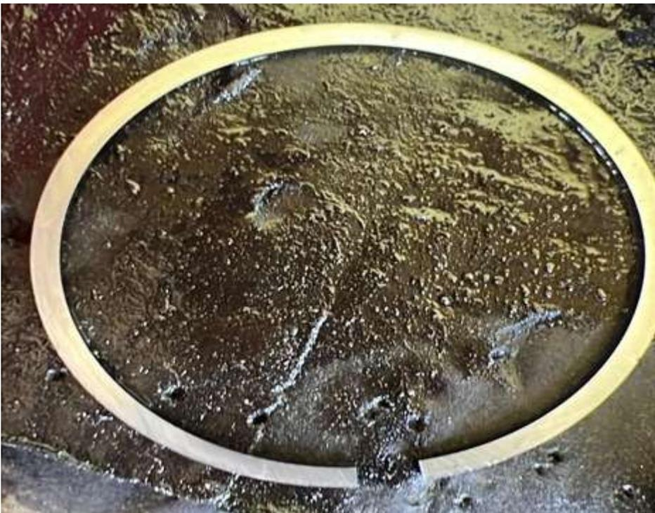
**Figura 56.** Segmento de compresión en óptimas condiciones del pistón #4.
