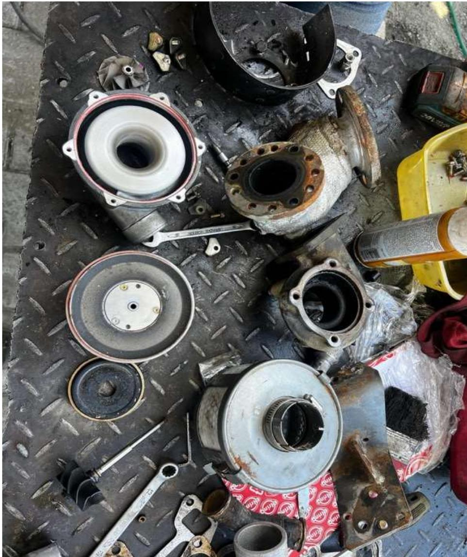
**Figura 69.** Visualización completa de las partes del sistema de admisión forzada.
