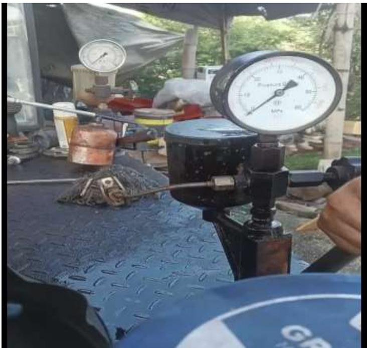
**Figura 89.** Prueba de presión y atomización del inyector #3.
