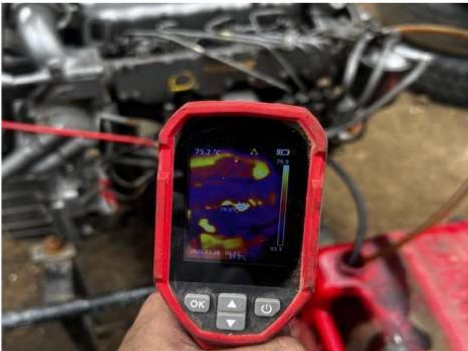
**Figura 41.** Temperatura de 79.9 °C en la bomba de inyección. La temperatura está dentro del rango de operación.
