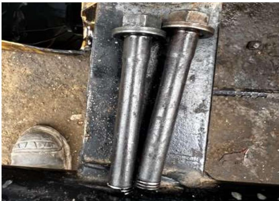
**Figura 47.** Varios pernos presentan fracturas durante el desmontaje del cabezote.
