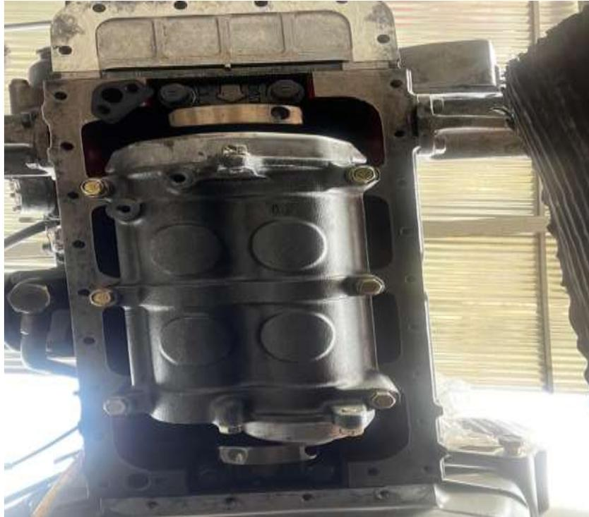
**Figura 74.** Acoplamiento de balanceador de cigüeñal
