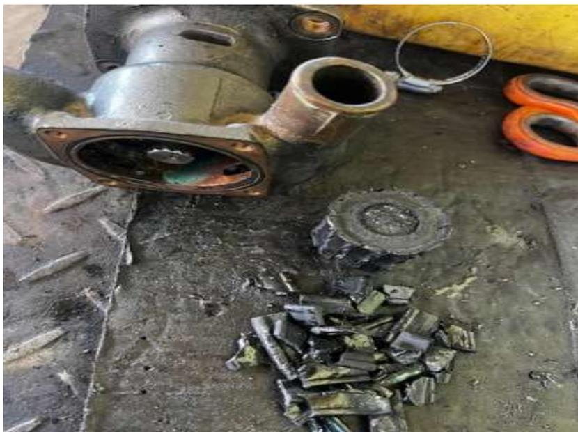
**Figura 60.** Partes del impeler fragmentados.
