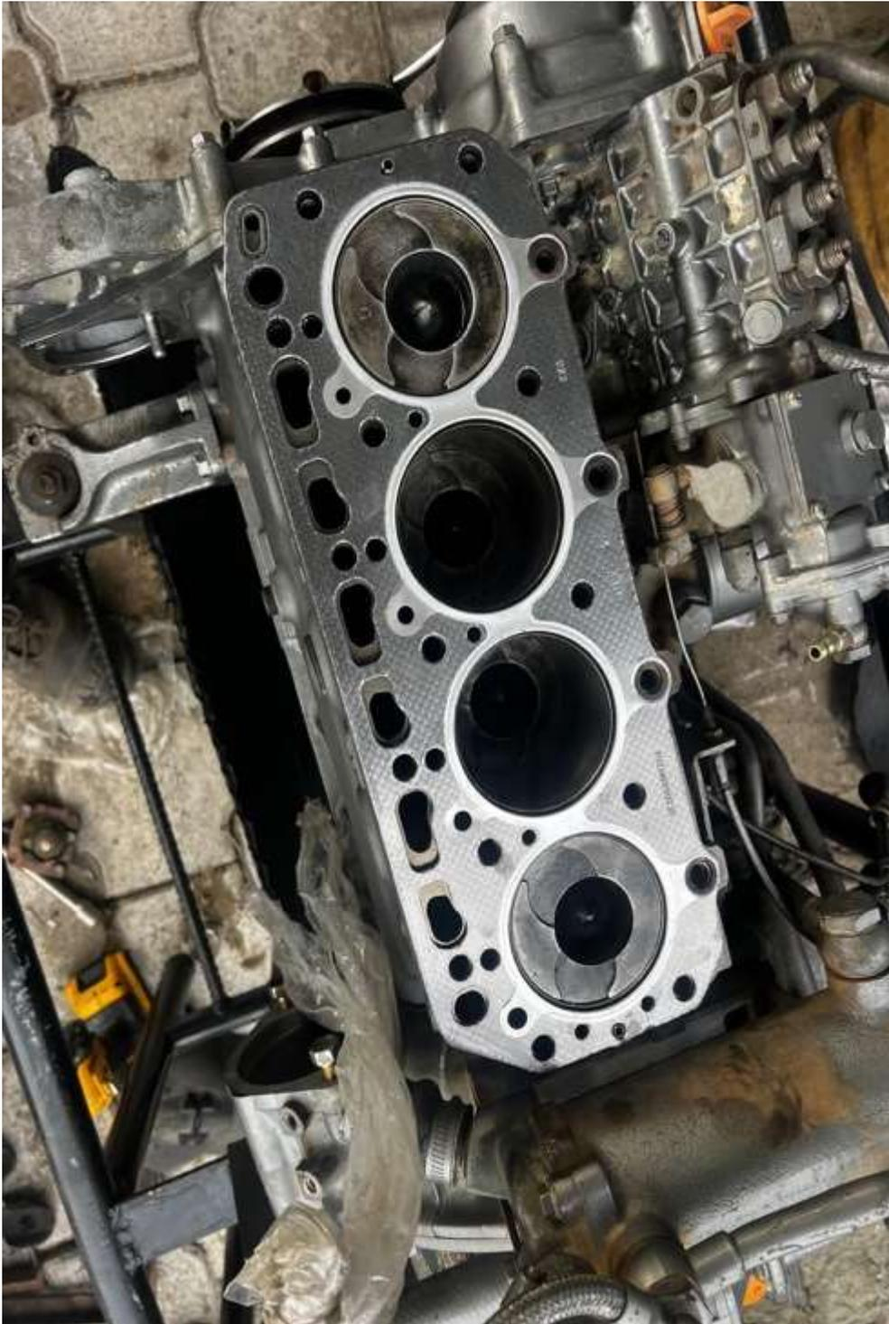
**Figura 73.** Colocación del pistón #1 y #4 y el nuevo empate de culata para garantizar su estanqueidad entre block y culata.
