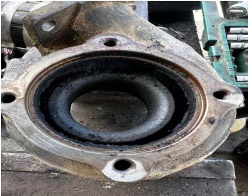
**Figura 63.** Carcasa del turbocompresor con presencia de hollín.
