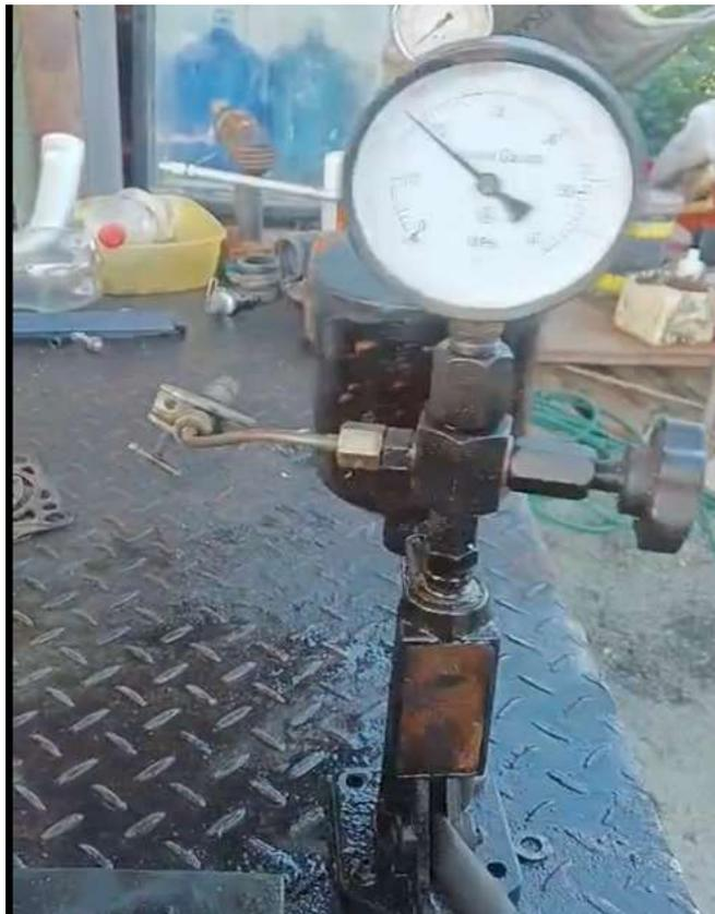
**Figura 87.** Prueba de presión y atomización del inyector #1.
