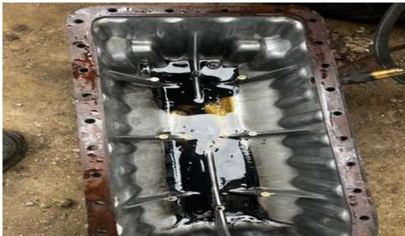
**Figura 49.** Residuos de lodo y hollín en el cárter. Limpieza del cárter para suministrar nuevo aceite.
