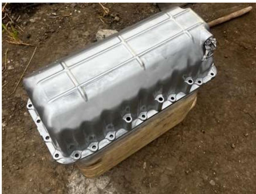
**Figura 75.** Pintado y colocación de empaque del cárter.
