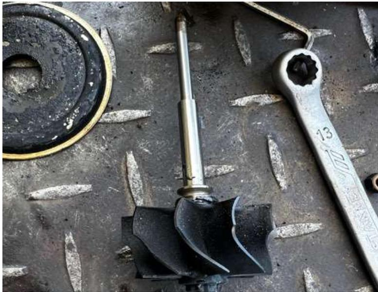
**Figura 68.** Eje de la turbina con hollín en el impeler.
