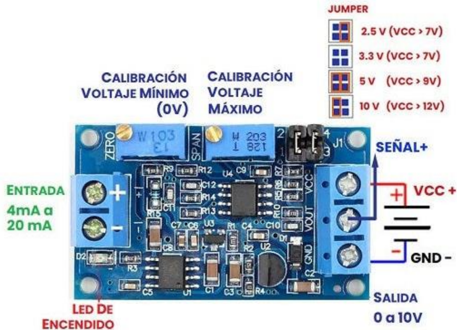
Ilustración 14. Módulo de conversión de señal de corriente (4–20 mA) (0–10 V)
