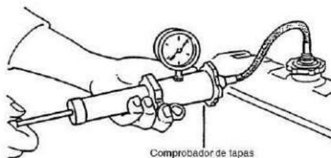
(Comprobación de fugas de agua en el sistema de refrigeración)
