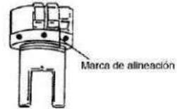
**(Marca de alineación del manguito de control/piñón de control del combustible)**
