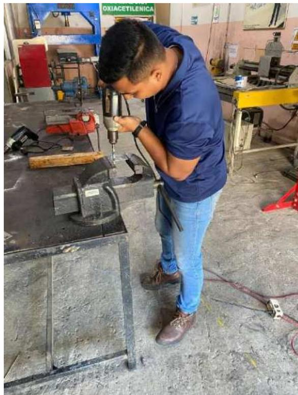
Haciendo orificios en una placa metálica
