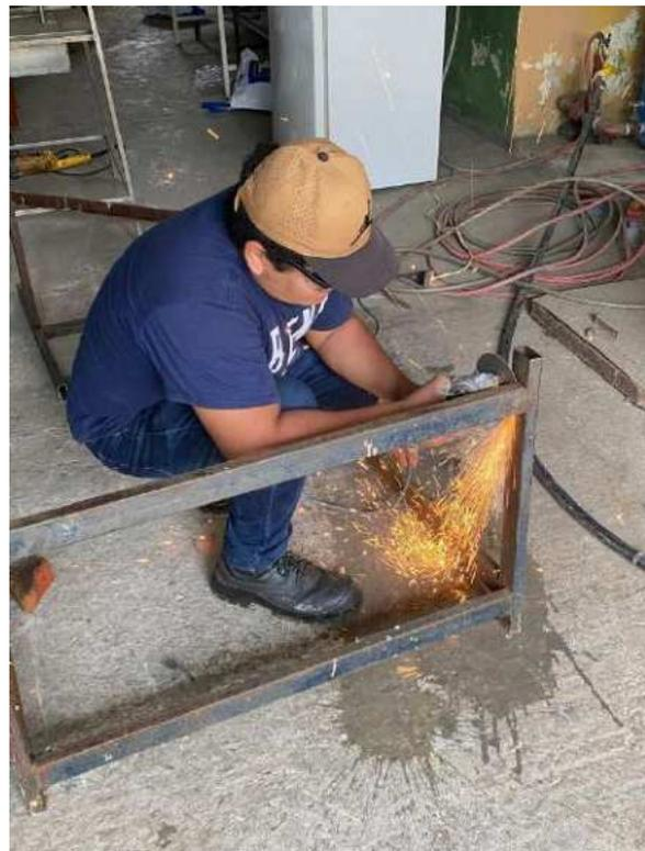
Cortando con la pulidora las medidas correspondientes de la base del motor.
