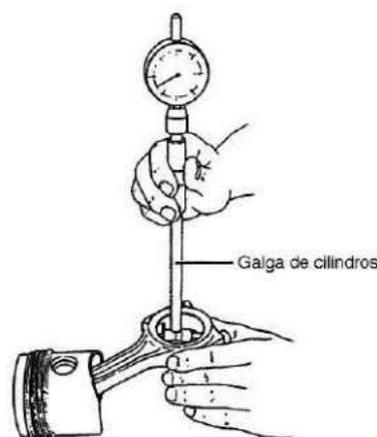
(Medición del diámetro interior del cojinete del muñón del cigüeñal)
