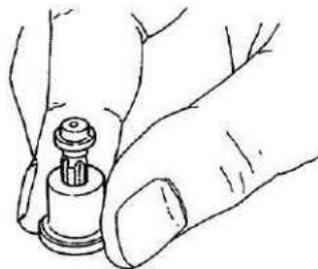
(Caída de la válvula de impulsión por la prueba de gravedad)
