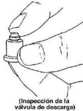
3. Al igual que se describió en el apartado 2, tape el agujero del fondo del soporte de la válvula de descarga para ver si la válvula de descarga cae perfectamente por su peso, cuando retira el dedo del agujero del fondo. Si sucede así, la válvula de descarga es válida. Si no, cámbiela.
