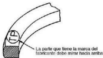
2. Ensamble el juego de segmentos con el cilindro, escalonando las uniones del juego de segmentos en intervalos de 120°, asegurándose de que no se alinean a lo largo del pistón. Aplique aceite lubricante a la circunferencia del pistón.
