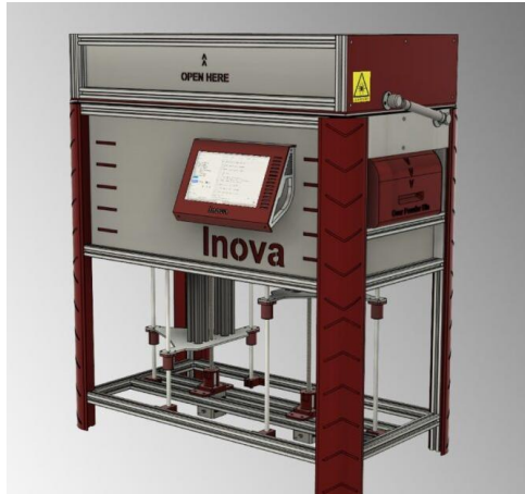
Figura 19. Impresora OpenSLS desarrollada por SLS4ALL. Fuente: SLS4ALL (2024)
