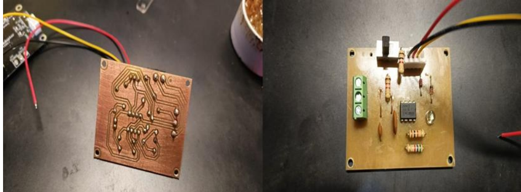
Figura 64. Placa de control PWM en PCB. Fuente: Elaboración propia
