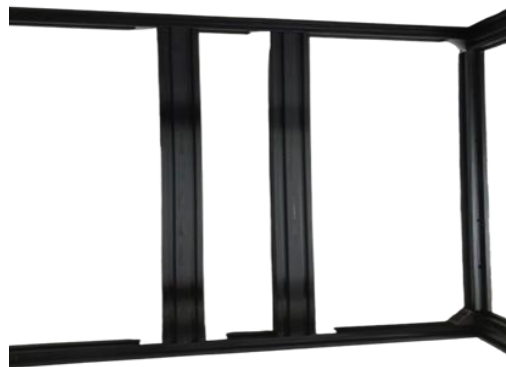
Figura 41. Ensamblaje para base de los motores.
