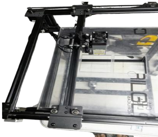
Figura 48. Integración de poleas y correas dentadas para movimiento del láser. Fuente: Elaboración propia
