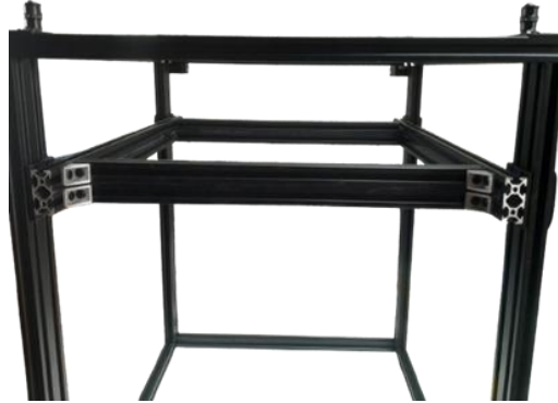
Figura 40. Refuerzo de la estructura con ángulos.
