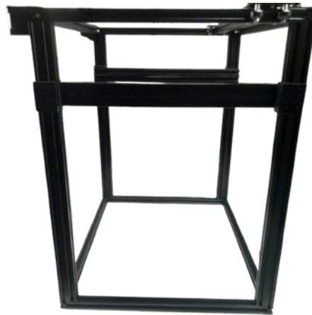
Figura 39. Ensamblaje de la estructura de la cama de sinterizado.
