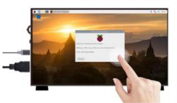
**Ilustración 22** Pantalla táctil GeekPi capacitiva de 10.1 in conectada por medio de un HDMI a la raspberry pi 4
