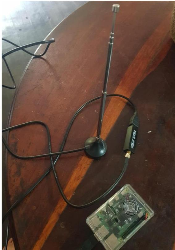
**Ilustración 33** Conexión física de receptor de radio
