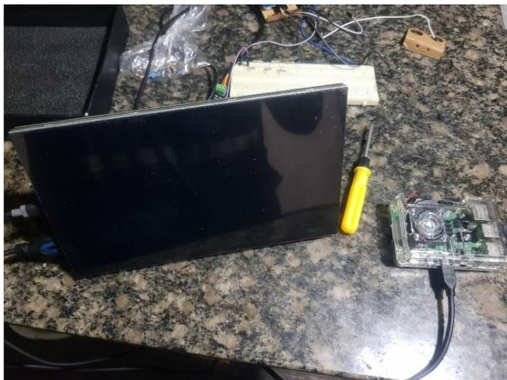
**Ilustración 27** Conexión de pantalla a la Raspberry pi 4
