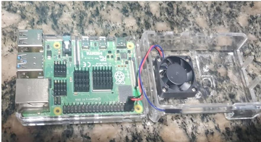
**Ilustración 24** conexión de ventilador y colocación de disipadores de calor
