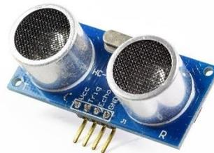
**Ilustración 15** Sensor Ultrasónico HCSR-04
