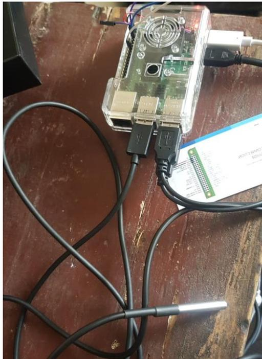
**Ilustración 36** Conexión física del sensor de temperatura
