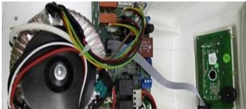
**Ilustración 1** Fuente de alimentación lineal.
