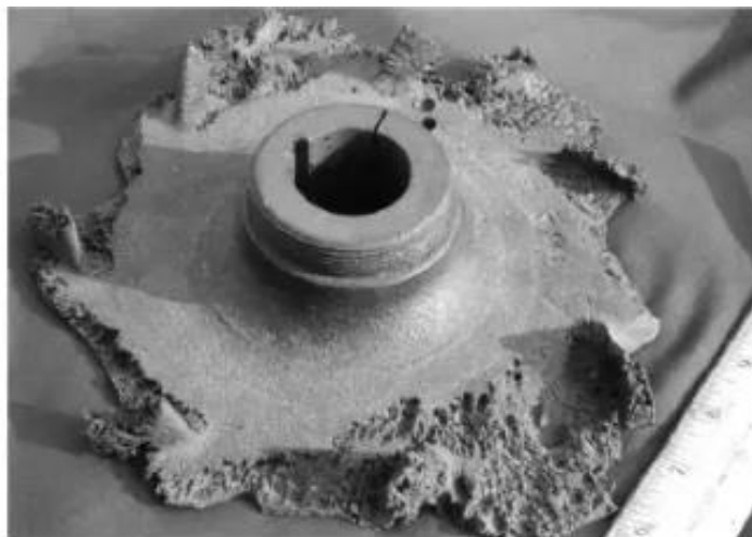
Figura 4:Corrosión conjunto con cavitación (Canchon, 2018)
