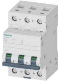
Automático magnetotérmico 400V 10kA, 3 polos, C, 25 A
