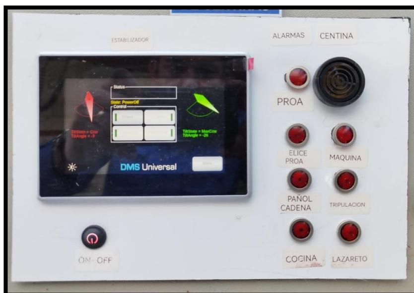
**Nota:** La imagen muestra un sistema estabilizador de giro de pala dinámica, diseñado para mantener el ángulo de ataque de la pala, izquierda babor(rojo), Derecha estribor(Verde). Figura propia.
