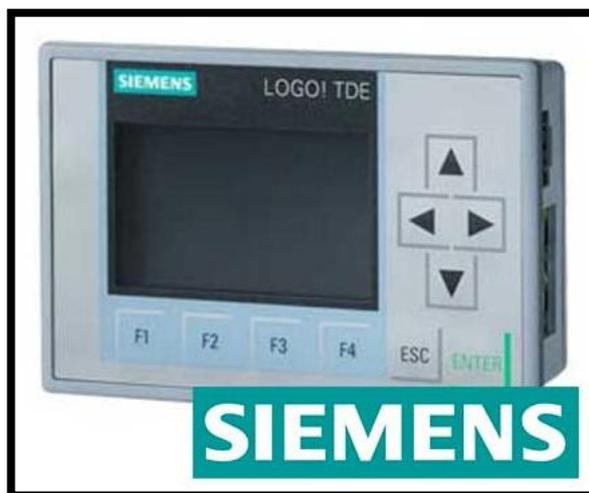
**Nota:** La imagen muestra la pantalla TDE Siemens LOGO, utilizada como interfaz externa para monitoreo y operación de sistemas automatizados. Extraído de Catálogo Siemens, 2019. <https://assets.new.siemens.com/siemens/assets/api/uuid:3ebdbea1-16bd-48ef-98a7-7d1bcbab94dc/logo8basicointermedio>.
