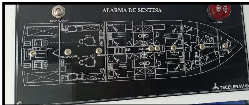
**Nota:** La figura representa un esquema de control de alarma de sentina, donde sensores de nivel detectan la acumulación de líquidos en la parte baja del casco. Figura propia.
