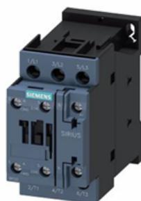
contactor de potencia, AC-3e/AC-3, 9 A, 4 kW/400 V, tripolar, 220 V AC, 50/60 Hz, contactos auxiliares: 1 NA + 1 NC, borne de tornillo, tamaño: S0
