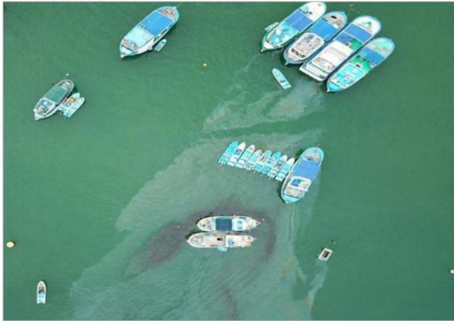
Figura 3. Descarga de Aceite quemado a través de la sentina en la Autoridad Portuaria de Manta
