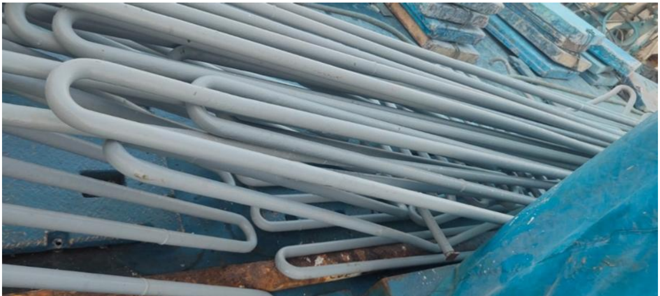
Figura 19. Serpentines listos para su instalación
