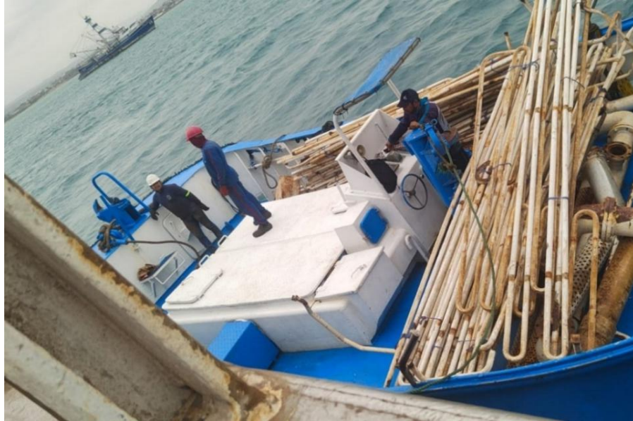
Figura 7. Retirada de serpentines extraídos de cubas
