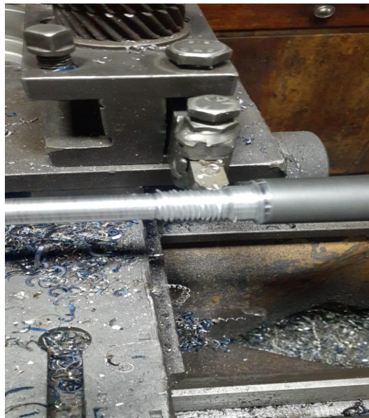
Figura 42 Realización de rosca en la parte superior del eje.
