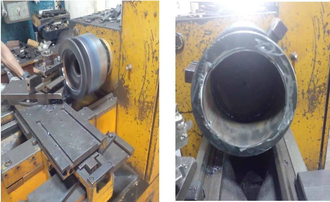
Figura 31 Acabado superficial de parte inferior del cajón de protección.
