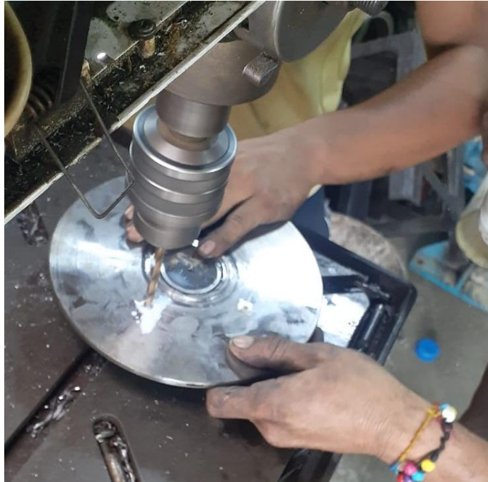
Figura 38 Realización de huecos pasantes para tapa inferior del rotor.
