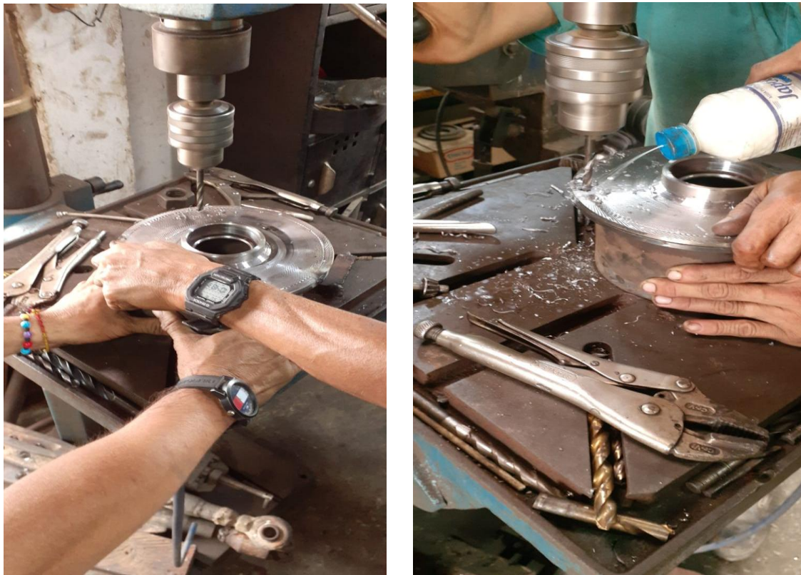
Figura 34 Realización de huecos con taladro de banco
