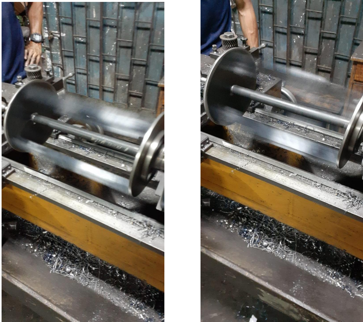
Figura 44 Pequeña prueba de giro a las aspas.
