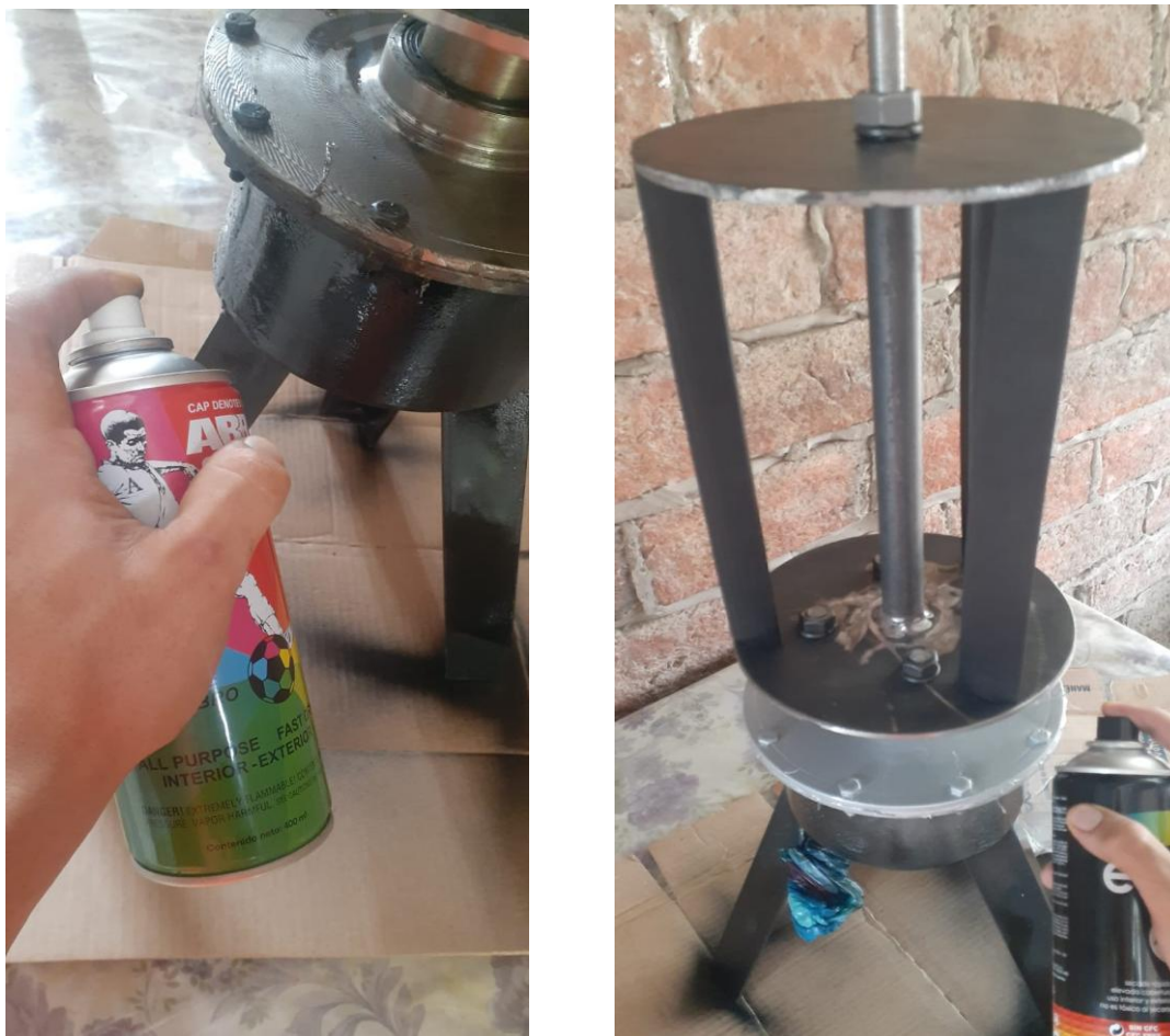
Figura 47 Puesta de capas de pintura al dispositivo.
