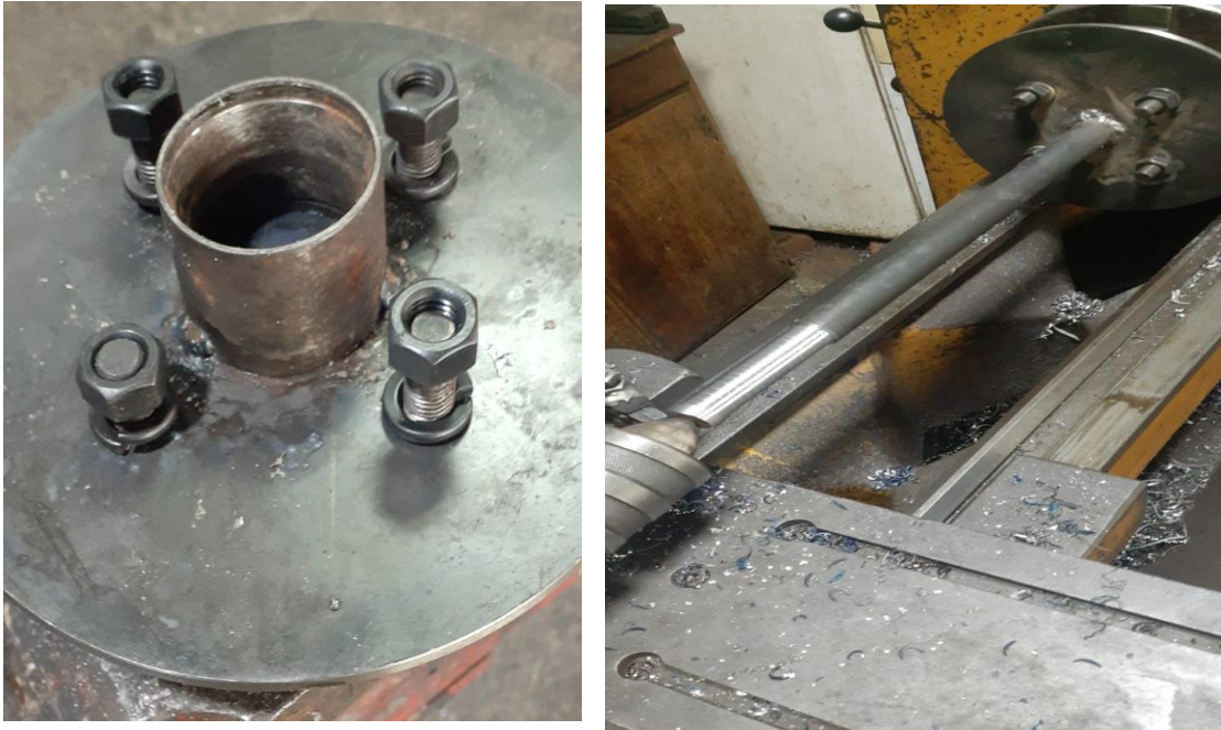
Figura 41 Adecuación del eje de la estructura.
