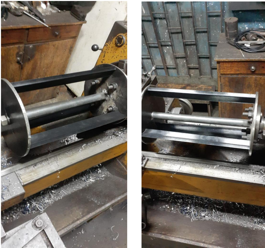
Figura 43 Montaje de aspas a estructura del eje.
