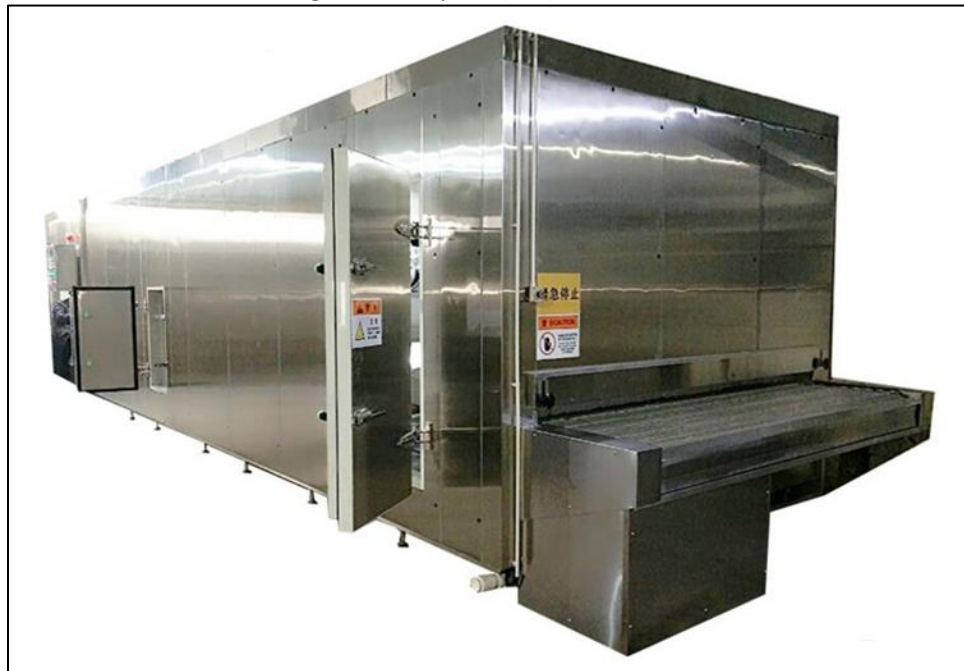
Ilustración 3 Túneles de congelación rápida (IQF)
