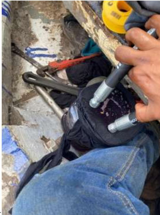
Ilustración 44 Filtración de aceite al momento de purgar el sistema
