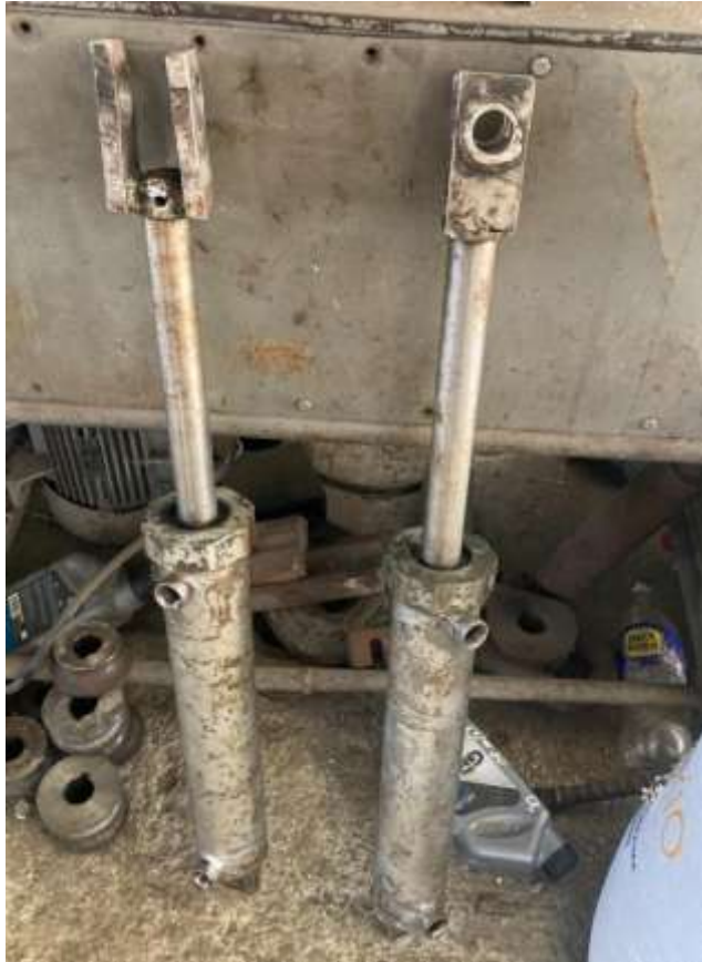
Ilustración 34 Gatos hidráulicos previos a reparación
