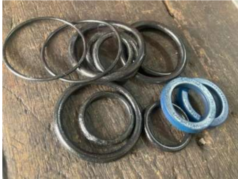
Ilustración 35 Retenedores y orings de los gatos hidráulicos de la embarcación "El Rey"
