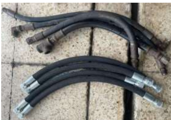
Ilustración 26 Mangueras nuevas para tanque de compensación
