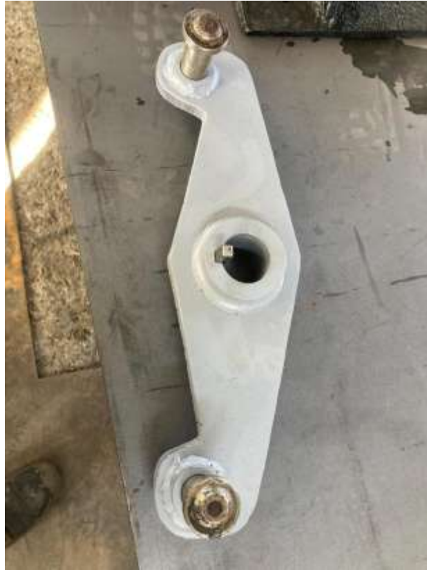
Ilustración 37 Abanico nuevo fabricado en el torno
