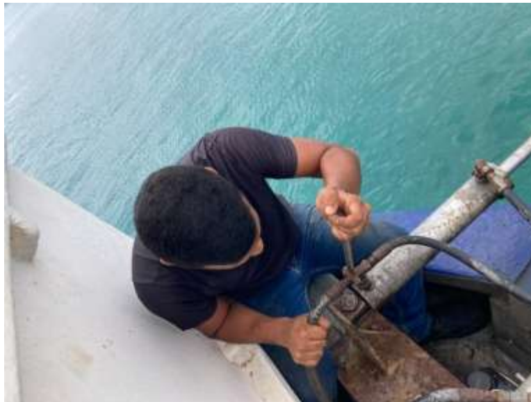
Ilustración 46 Desmontaje de gatos hidráulicos
