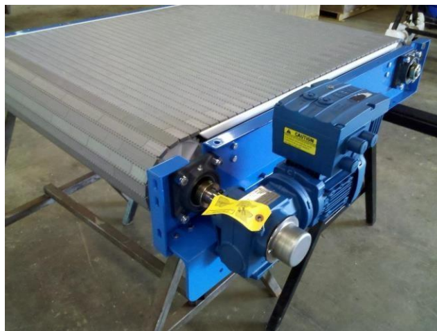
Figura 9 Sistema de banda transportadora con reductor de velocidad
