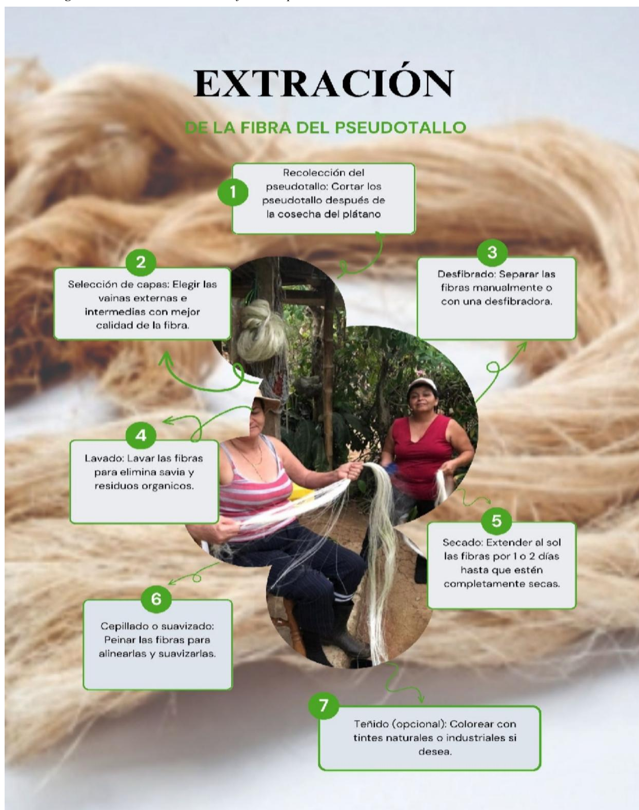
Figura 32 Proceso de extracción de fibras del pseudotallo
