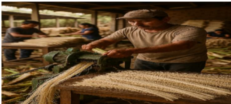
Figura 4. Extracción de fibras del Pseudotallo.
