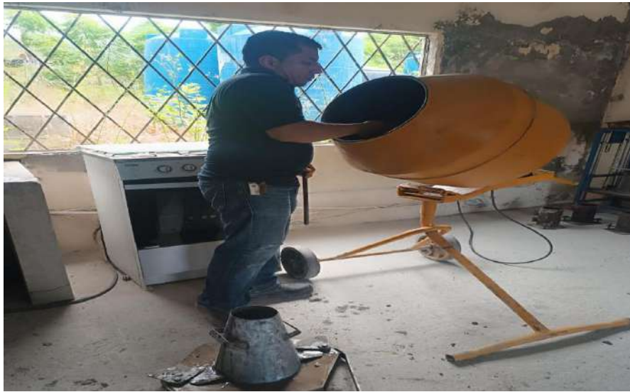
Ilustración 1, Elaboración de la mezcla diseñada en las instalaciones del laboratorio de conrenor.
