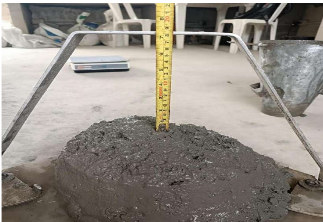
Ilustración 3, prueba con el cono de Abrams, para verificar la consistencia de 18 cm por la cual fue diseñada
