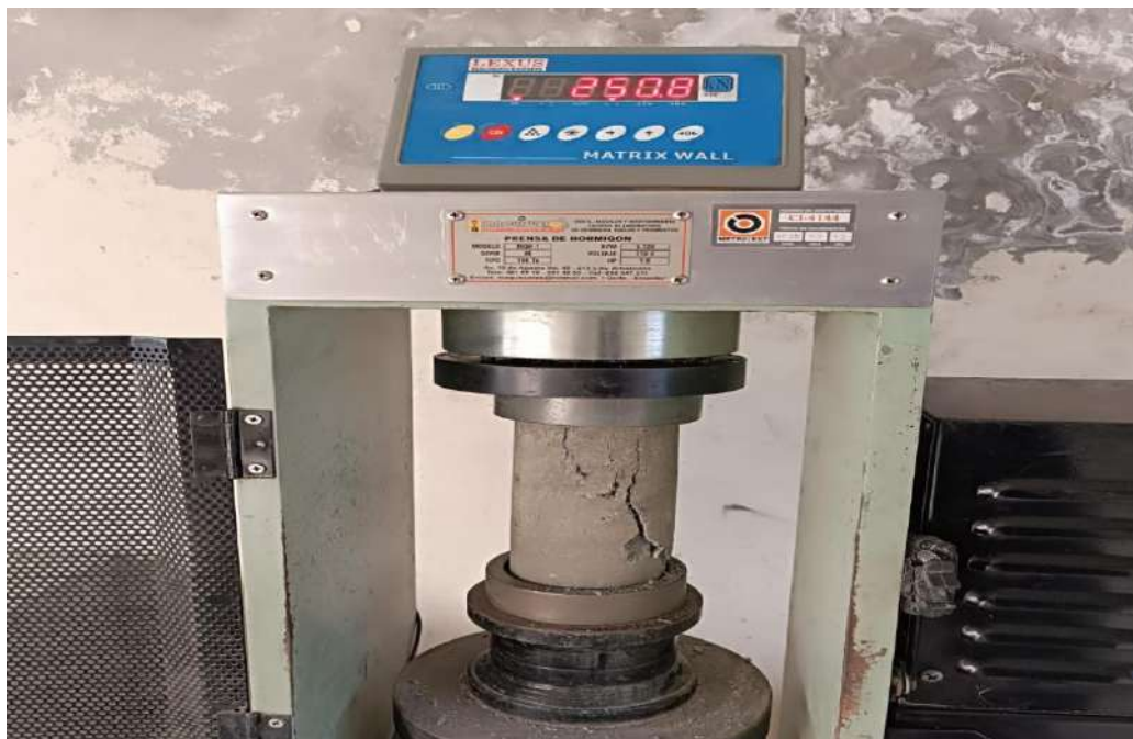
Ilustración 8, rotura de cilindro en prensa hidráulica a la edad de 28 días obteniendo una resistencia final de 325 kg/cm2 cumpliendo satisfactoriamente con el diseño teórico realizado.
