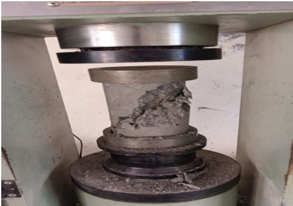
Ilustración 6, rotura de cilindro en prensa hidráulica a la edad de 7 días.
