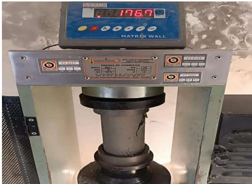
Ilustración 7, rotura de cilindro en prensa hidráulica a la edad de 14 días.
