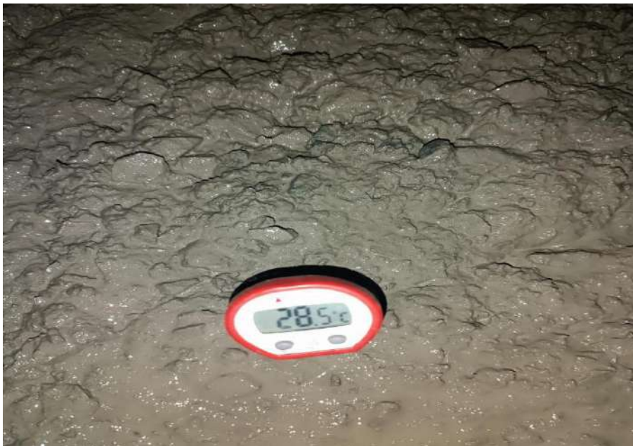
Ilustración 2 verificación de la temperatura del hormigón 28.5°C en la muestra elaborada.
