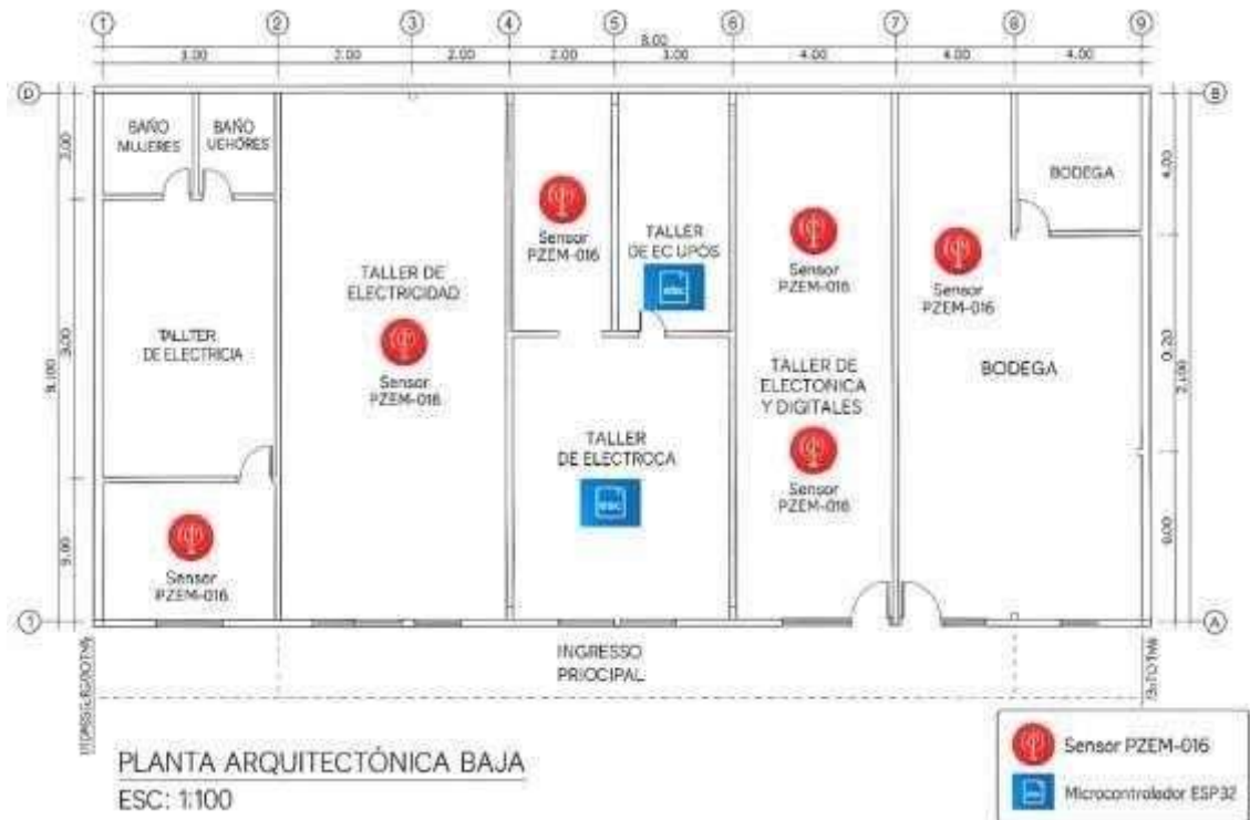
Ilustración 2: Propuesta de ubicación de los sensores y microcontroladores
