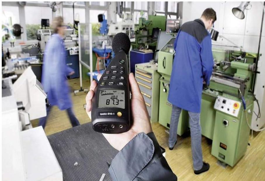
Ilustración 1: Medición de valores de ruidos
